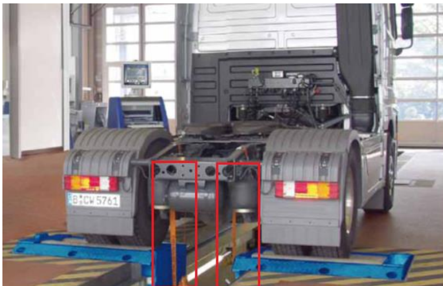
Slika 24. Sidrište na kućištu diferencijala[11]
