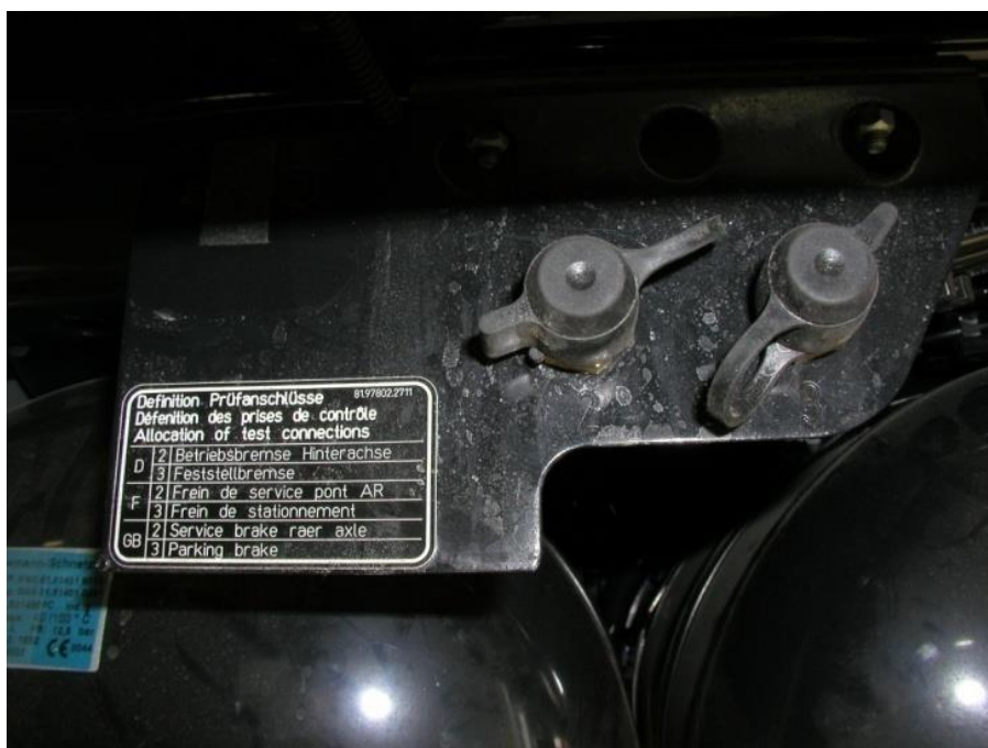
Slika 1. Kontrolni priključci za spajanje manometra
