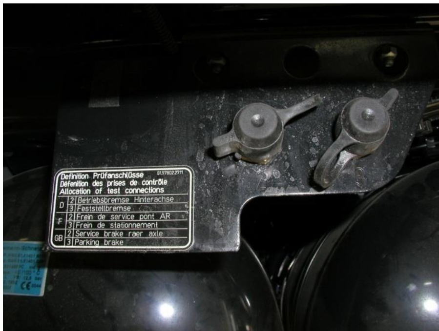
Slika 1. Kontrolni priključci za spajanje manometra
