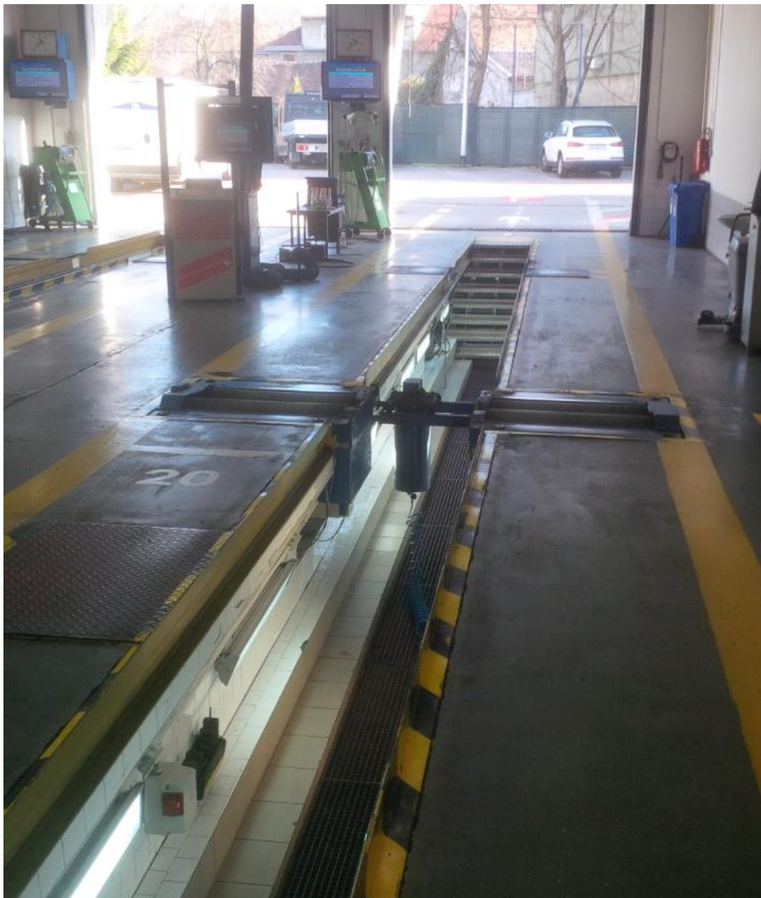
Slika 5. Kanal za tehnički pregled vozila
