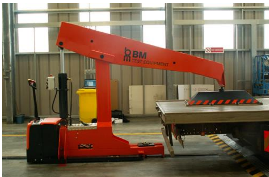
Slika 9. Mobilni uređaj za opterećivanje tovarnog prostora vozila[7]
