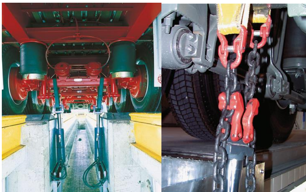
Slika 10. Povlačenje osovine sa hidraulikom[8]
