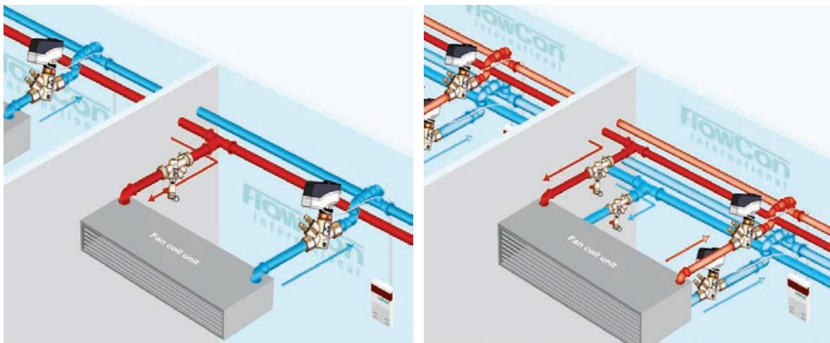
Slika 4: Dvocijevni i četverocijevni sustav ventilokonvektora [13]
