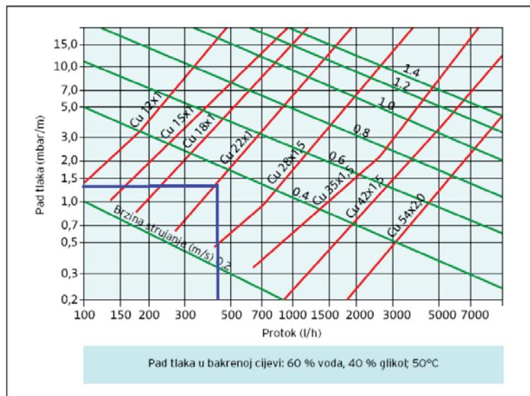
Slika 24: Pad tlaka u cjevovodu solarnog kruga [7]
