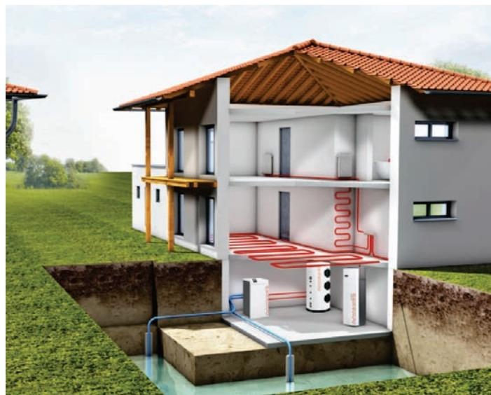
Slika 9: Dizalica topline sa podzemnom vodom kao izvorom energije [16]
