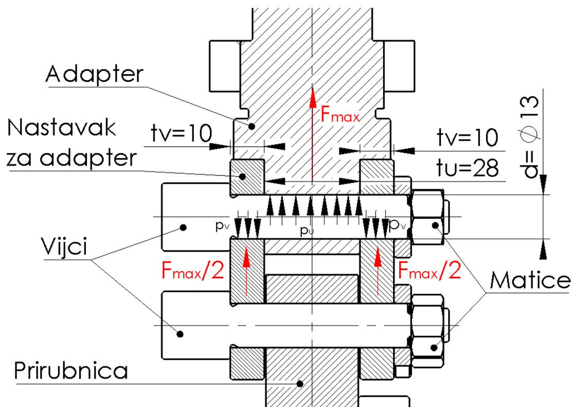
Slika 63. Presjek proračuna zatika
