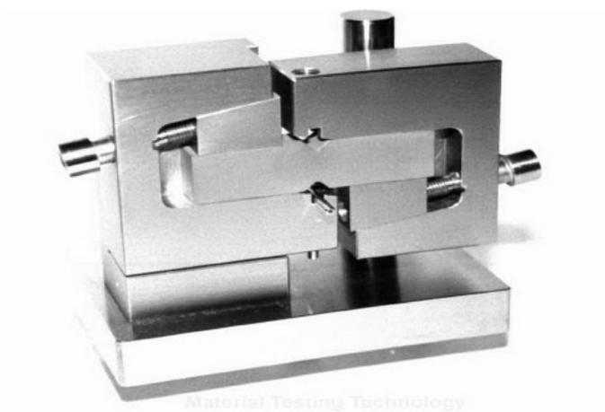
Slika 14. Iosipescu naprava za smično ispitivanje [10]
