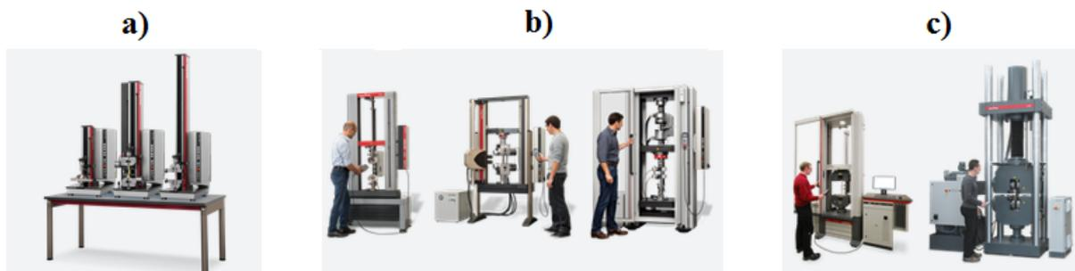
Slika 34. Zwick/Roell standardni strojevi za ispitivanje [32]
