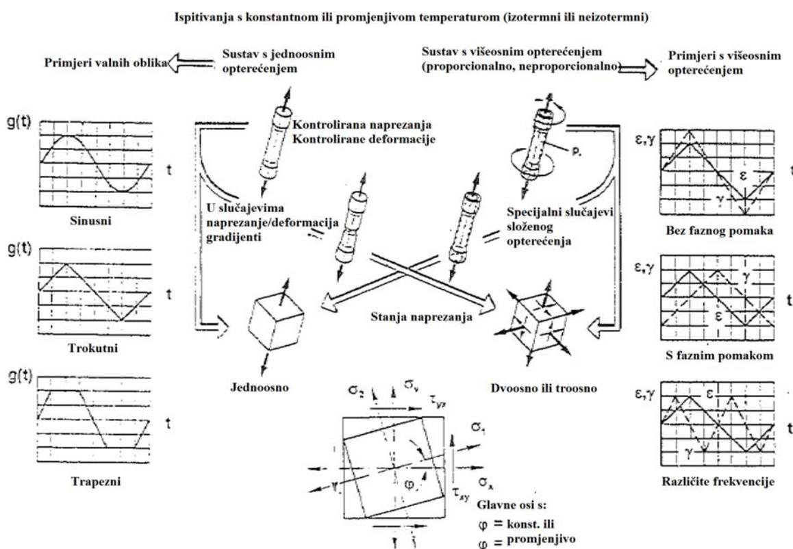
Slika 15. Usporedba jednoosnih i višeosnih opterećenja [14]
