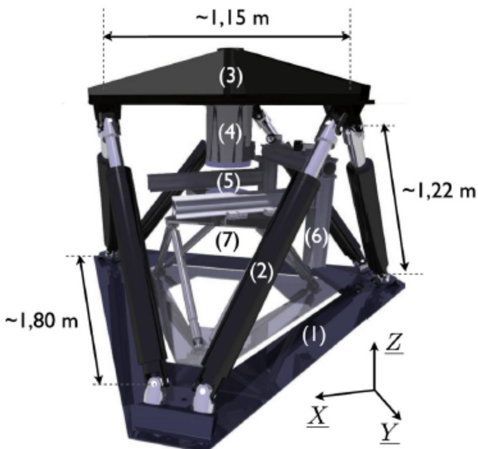
Slika 25. CAD model 6-osnog ispitnog stroja [17]
