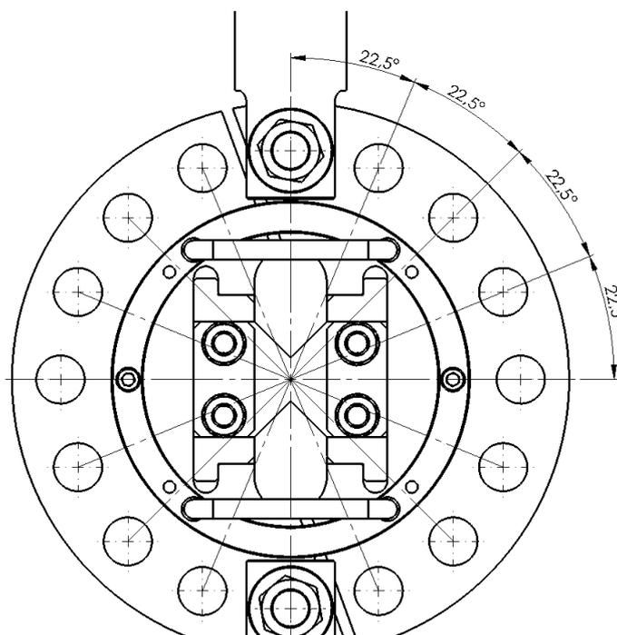
Slika 52. Prikaz rasporeda provrta na konceptu 3
