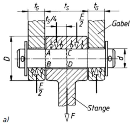
Slika 64. Prikaz raspodjele opterećenja zatika prema [25]
