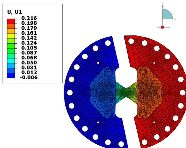
Slika 72. Reducirano savijanje konstrukcije konačnog modela Arcan prihvata uslijed vlačnog opterećenja [27]
