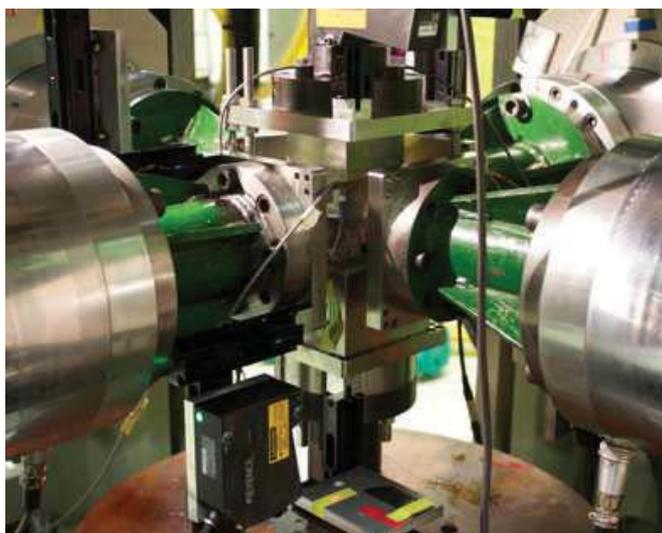
Slika 18. Troosni uređaj spojen na ispitni stroj ASTREE [18]
