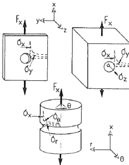
Slika 23. Vrste uzoraka sa zarezom s postavljenim naprezanjima [14]
