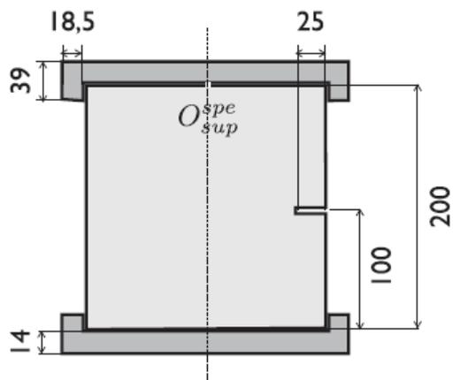
Slika 26. Geometrija ispitnog uzorka za 6-osno ispitivanje [17]
