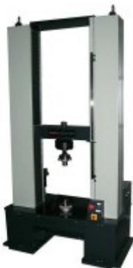
**Slika 32. 300 Serija standardnog stroja za ispitivanje na vlak [4]**
