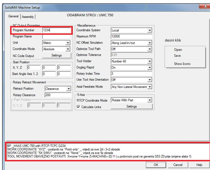
Slika 78. Primjer definiranog Post-procesora 5-osnog CNC stroja
