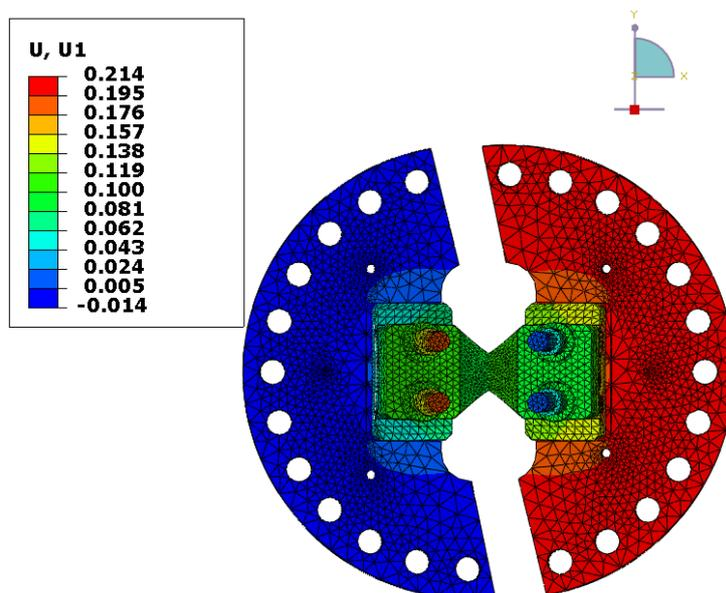
Slika 71. Savijanje konstrukcije konačnog koncepta Arcan prihвата uslijed vlačnog opterećenja [27]
