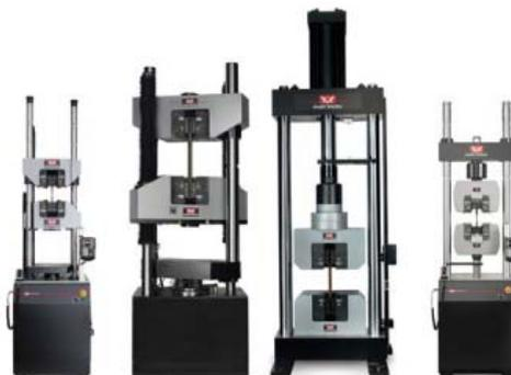
Slika 37. Instron standardni statičko hidraulički stroj [7]
