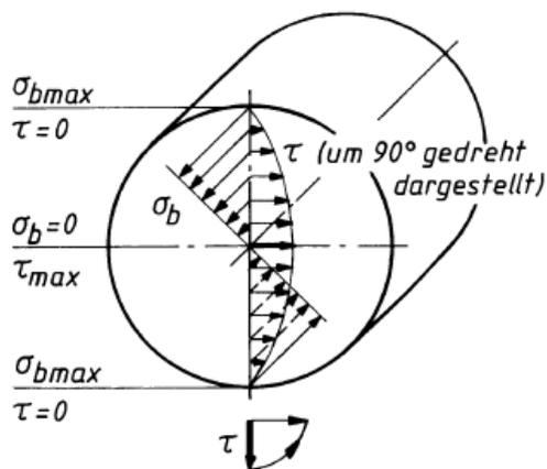
Slika 66. Prikaz smičnog i savojnog opterećenja [25]
