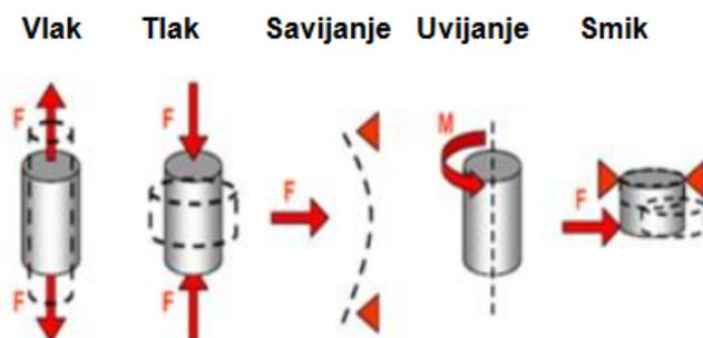
Slika 3. Statička kratkotrajna opterećenja [2]
