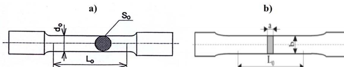
**Slika 7. Karakteristični uzorci za provedbu statičkog vlačnog ispitivanja, a) ispitni uzorak s kružnim poprečnim presjekom, b) ispitni uzorak s kvadratnim poprečnim presjekom**
