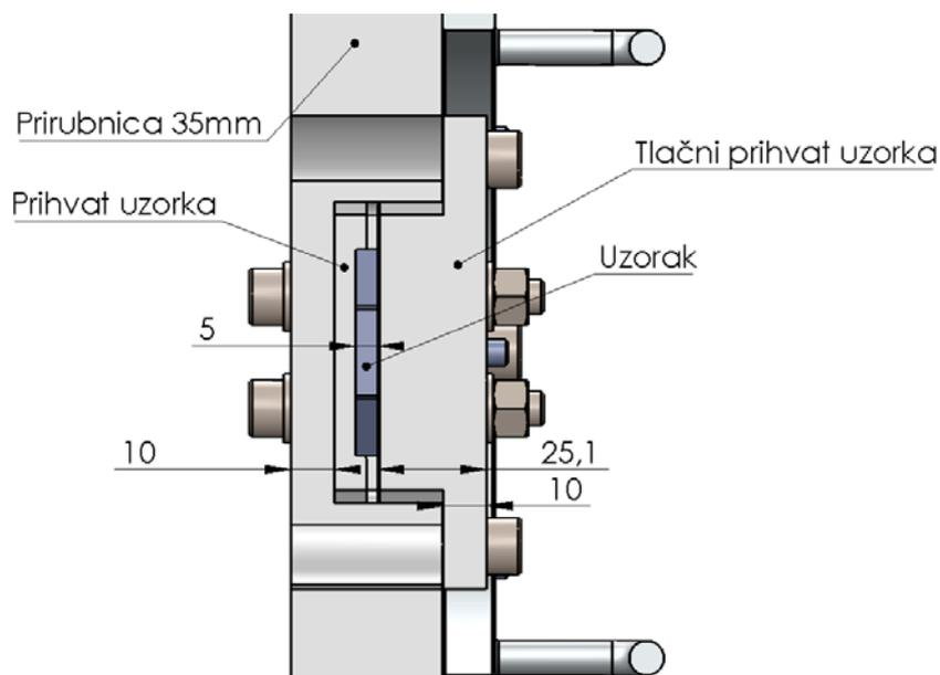
Slika 73. Dijelova koji su izmjenjeni u konstrukciji konačnog modela Arcan prihvata
