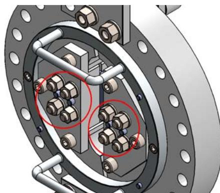
Slika 75. Konstrukcijski dodani vijci i zatici za prihvata uzorka
