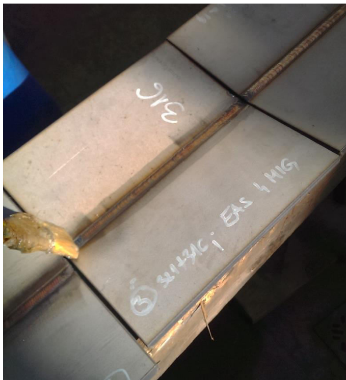
Slika 33. Nanošenje BEIZPASTE kistom
