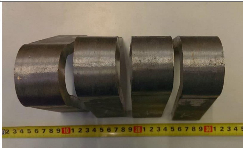
Slika 46. Rezultati savijanja epruveta ispitnog uzorka 2
