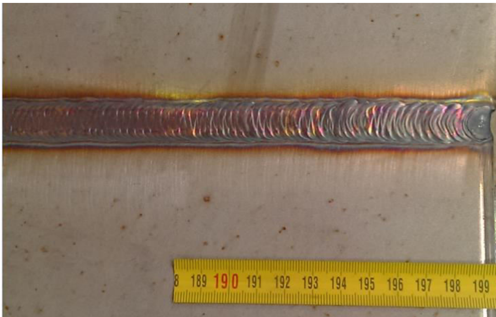
Slika 23. Izgled zavara ispitnog uzorka 1
