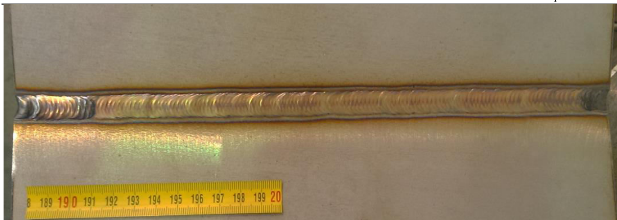
Slika 29. Zavareni spoj ispitnog uzorka 2
