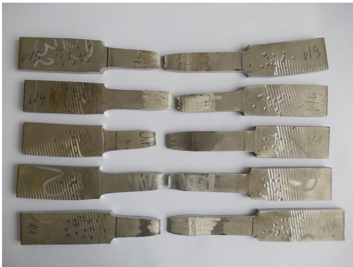
Slika 51. Izgled epruveta nakon statičko - vlačnog ispitivanja
