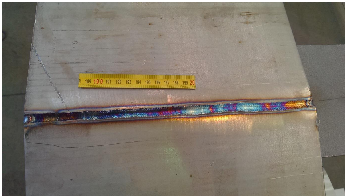
Slika 25. Zavareni spoj sa strane korijena nakon protaljivanja
