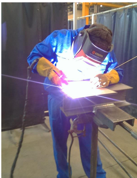
Slika 22. Zavarivanje prve popune uzorka 1
