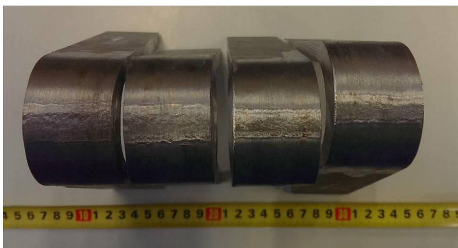
Slika 45. Rezultati savijanja epruveta ispitnog uzorka 1
