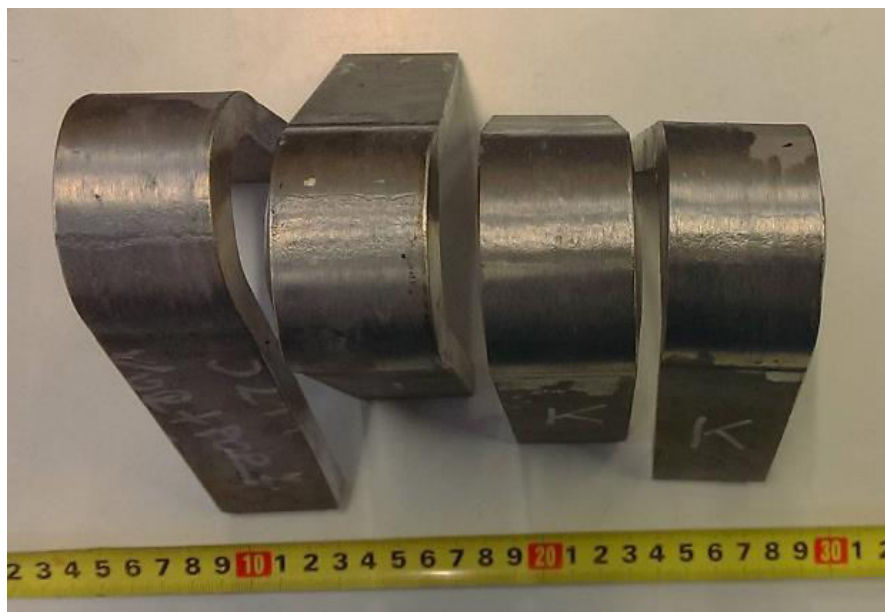
Slika 49. Rezultati savijanja epruveta ispitnog uzorka 5
