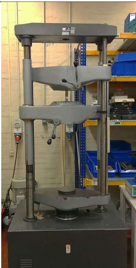
Slika 50. Statičko - vlačno ispitivanje ispitnog uzorka 2 na kidalici EU 40 MOD
