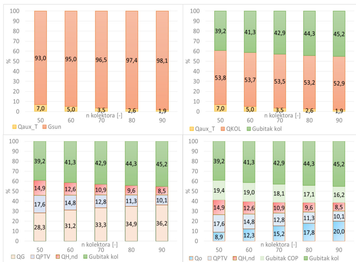
Slika 3.59. Tijek pretvorbe 100% pogonske energije u korisnu energiju, rashladni učin i gubitke sustava
