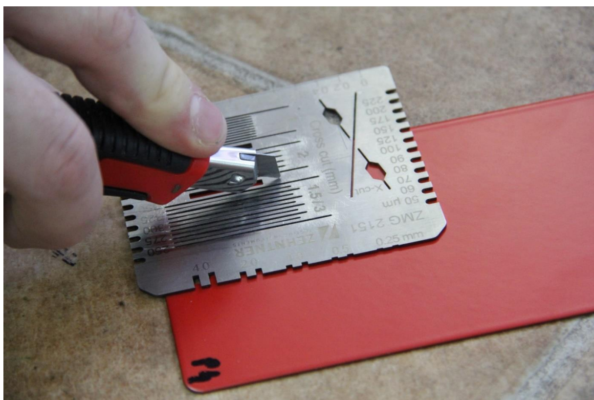
Slika 30. Ispitivanje prionjivosti premaza Cross – cut testom
