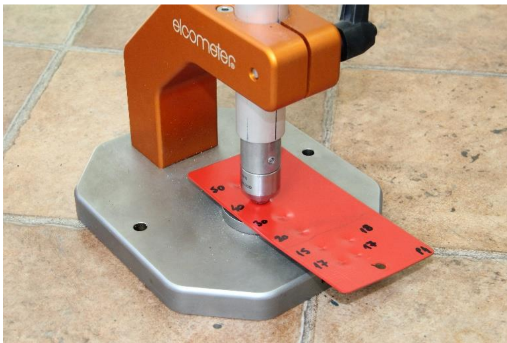
Slika 28. Ispitivanje otpornosti premaza na udar
