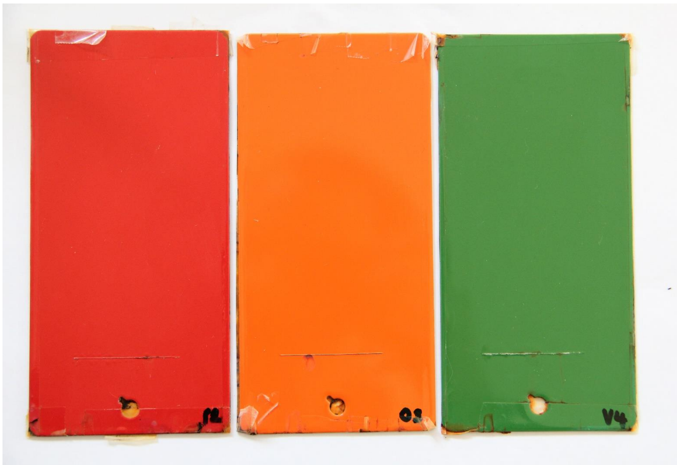
Slika 40. Uzorci nakon 240 sati ispitivanja u slanoj komori
