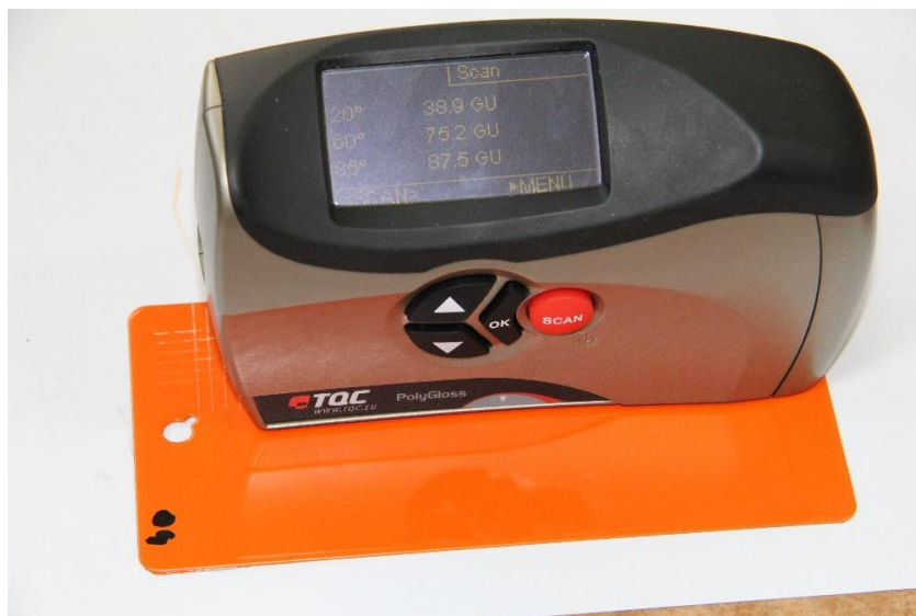
Slika 24. Ispitivanje sjaja premaza uređajem TQC POLYGLOSS
