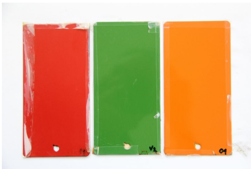
Slika 47. Uzorci nakon 240 sati ispitivanja u vlažnoj komori
