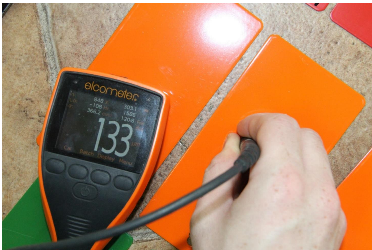
Slika 23. Mjerenje debljine suhog filma premaza uređajem Elcometer 456/4
