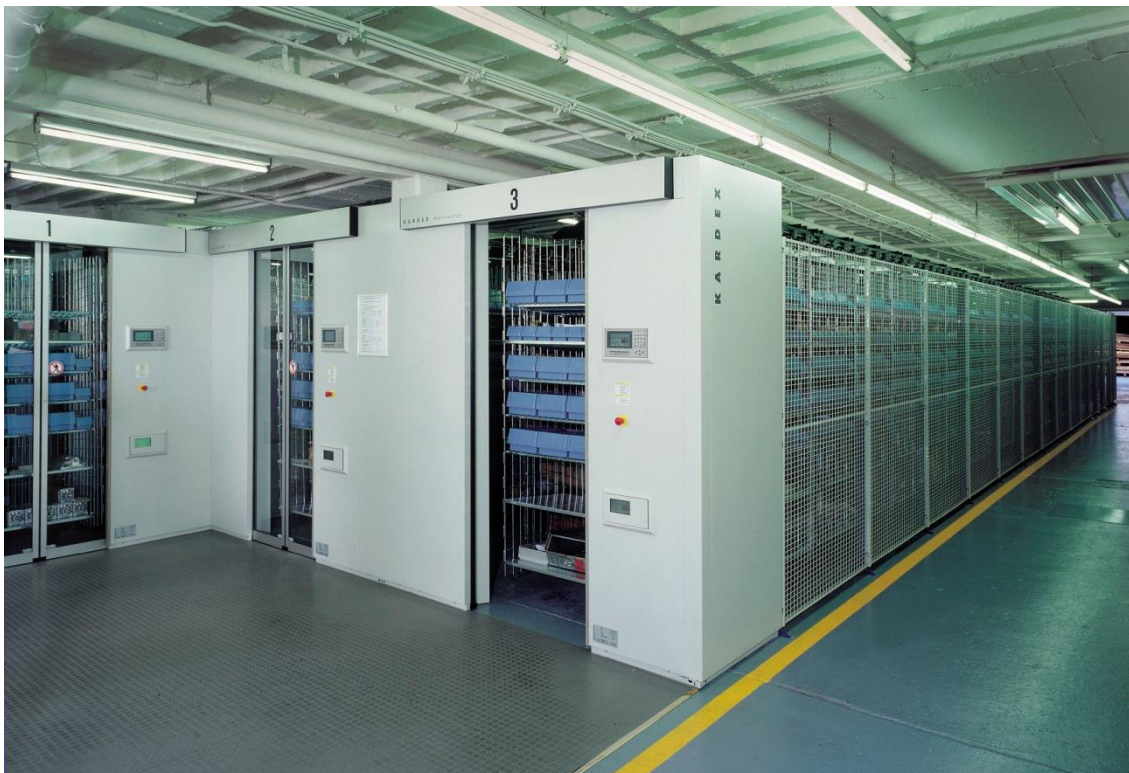
Slika 6. Izvedba automatiziranog horizontalnog karusela [5]
