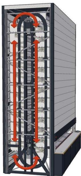
Slika 23. Princip rada Megamat RS sustava – paternoster [9]
