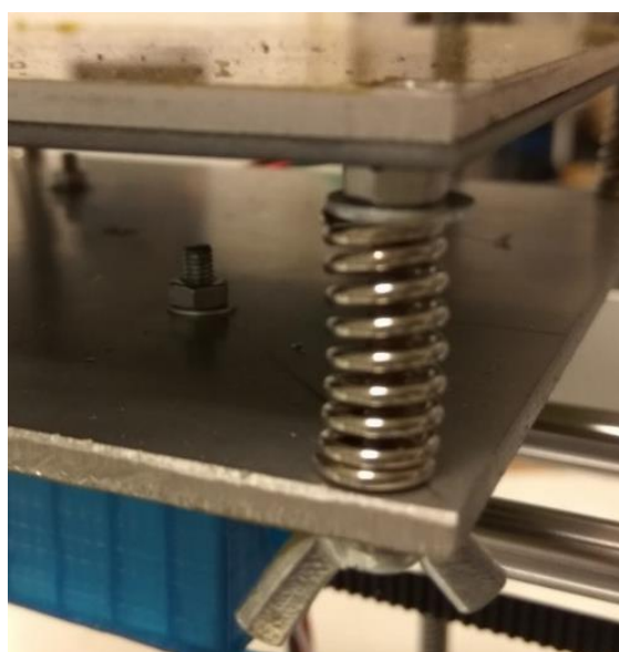
Slika 4.19. Montaža grijaće površine
