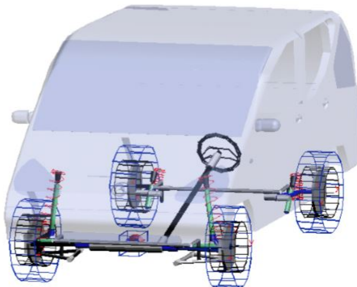
Slika 23. Simulacijski model za Mercedes-Benz A-klasu [11]
