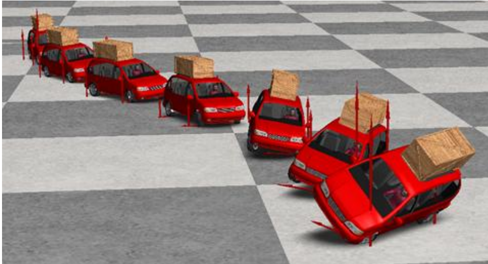
Slika 105. Animacija prevrtanja vozila, Fishhook, teret na krovu
