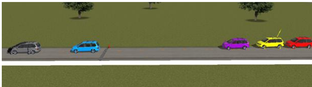
Slika 128. Vozila na cilju trkaće staze (crno- pneumatici 255/45 R18, sivo- pogon na sve kotače, plavo- opruge 50 %, ljubičasto- pogon na sve kotače, žuto- standardno vozilo, crveno- stražnji pogon)
