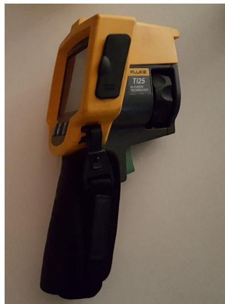
Slika 7. Termografska kamera „Fluke Ti25“
