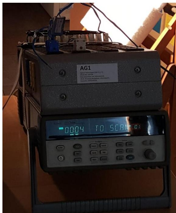
**Slika 9. Analogno-digitalni pretvarač signala**
