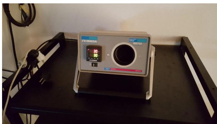
**Slika 8. Kalibracijsko crno tijelo „Omega BB702“**
