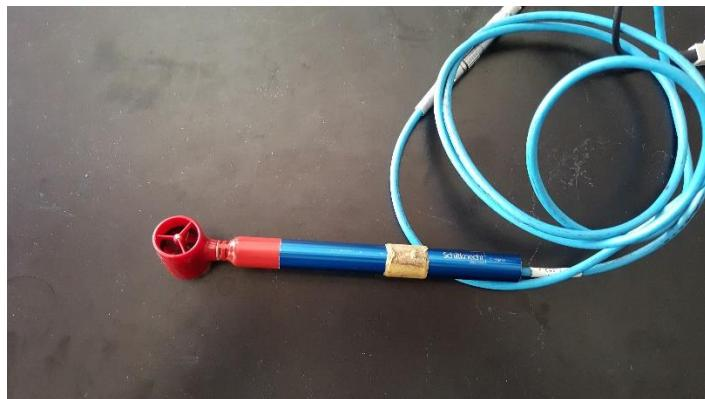
Slika 27. Anemometar s rotirajućim vrhom
