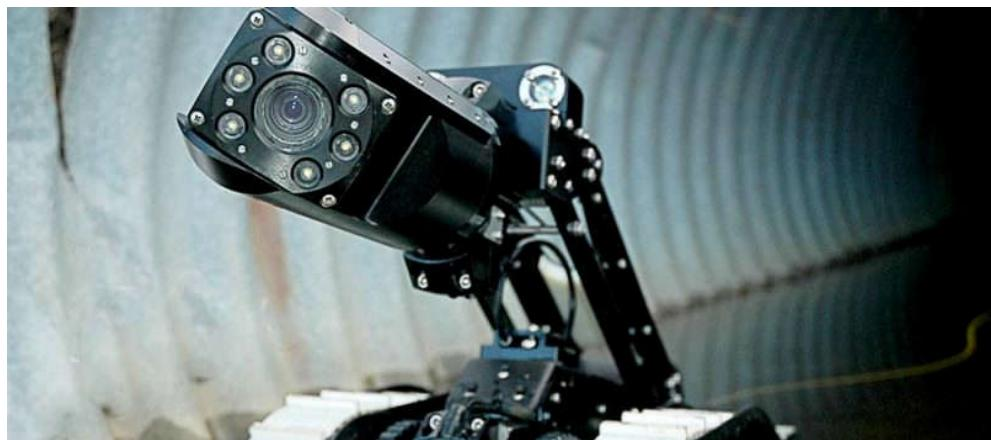
**Slika 19. Kamera za inspekciju cijevi [39]**
