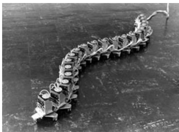
Slika 11. Zmijoliki robot ACM III [24]
