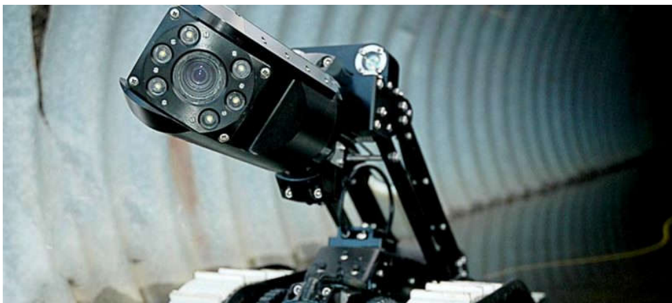
Slika 19. Kamera za inspekciju cijevi [39]
