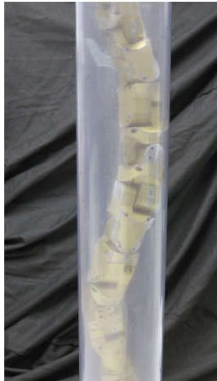
**Slika 24. Penjanje robota uz okomitu cijev [15]**
