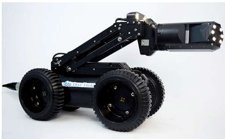
Slika 22. Robot s produžnom rukom [39]
