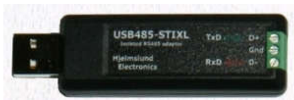
Slika 74. USB RS-485 pretvarač [56]
