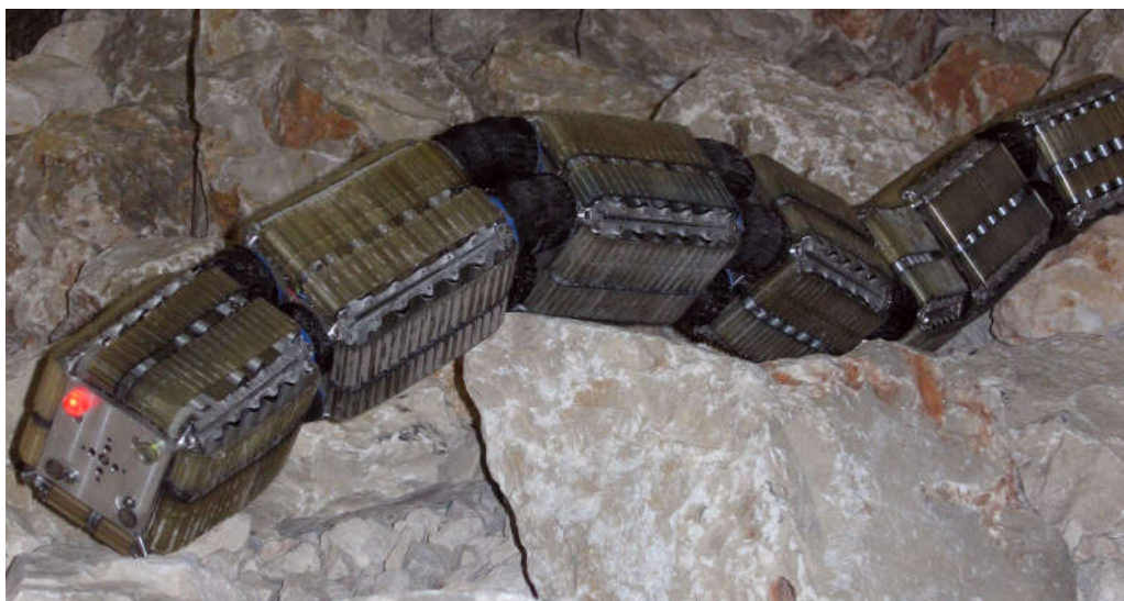
Slika 14. Zmijoliki robot OmniTread OT-4 [29]
