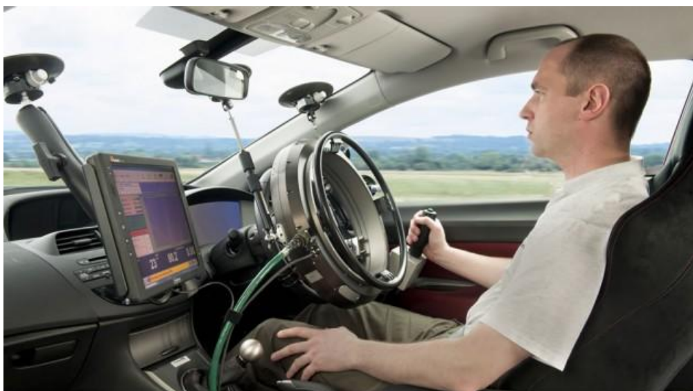
Slika 7. Ispitivanje u otvorenoj petlji [9]
