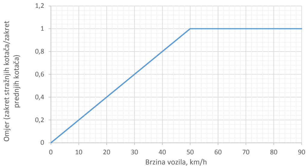
Slika 44. Funkcija promjene kuta zakreta stražnjih u odnosu na prednje kotače
