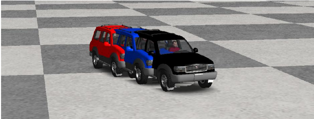
Slika 69. Simulacija ispitne procedure ISO 7401:2011
