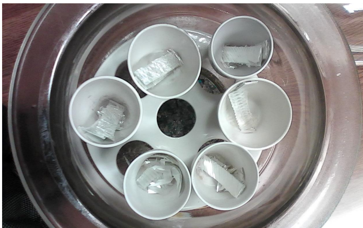
Slika 6.18. Ispitna tijela nakon postupka žarenja
