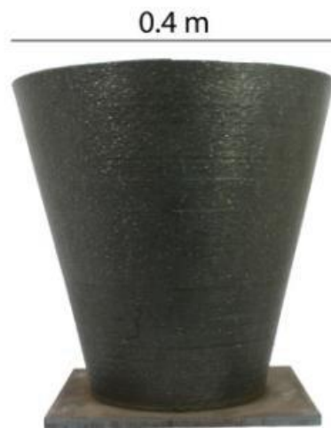
Slika 14. Čelični stožac izrađen WAAM postupkom [9]
