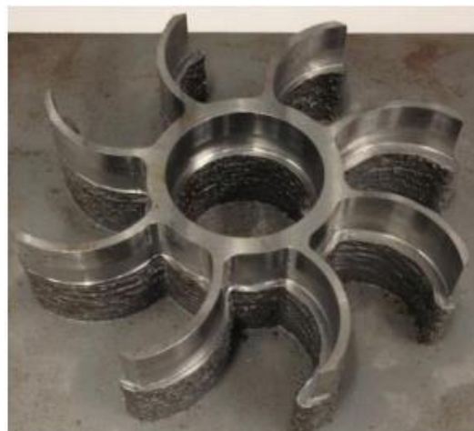
Slika 15. Rotor izrađen WAAM postupkom [11]
