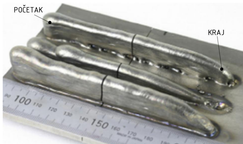
Slika 30. Razlika u geometriji zavara na početku i na kraju prolaza [6]
