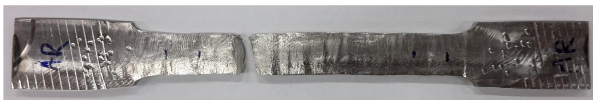
Slika 67. Epruveta uzorka 1 nakon ispitivanja
