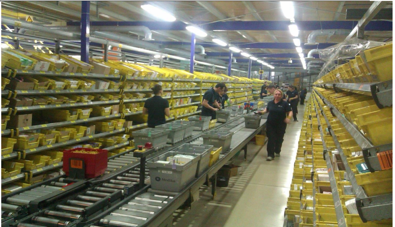
Slika 4.8. Komisioniranje u zoni „WMS-a“ – pokretna traka
