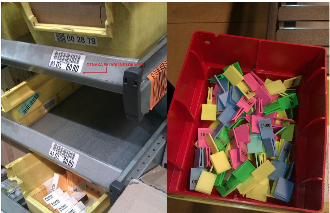
Slika 4.9. Oznaka skladišne lokacije protočnog regala i kvačice za označavanje spremnika
