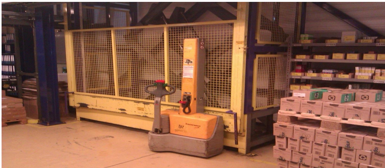
Slika 3.20. Hidraulična škarasta platforma
