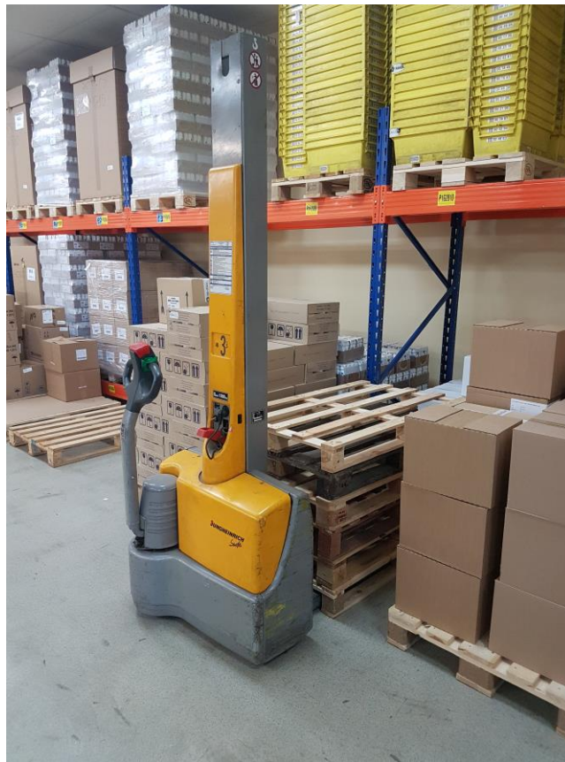
Slika 3.17. Električni visokopodizni viličar EMC 110
