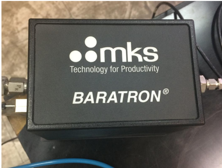
Slika 14. Pretvornik tlaka Baratron 120A
