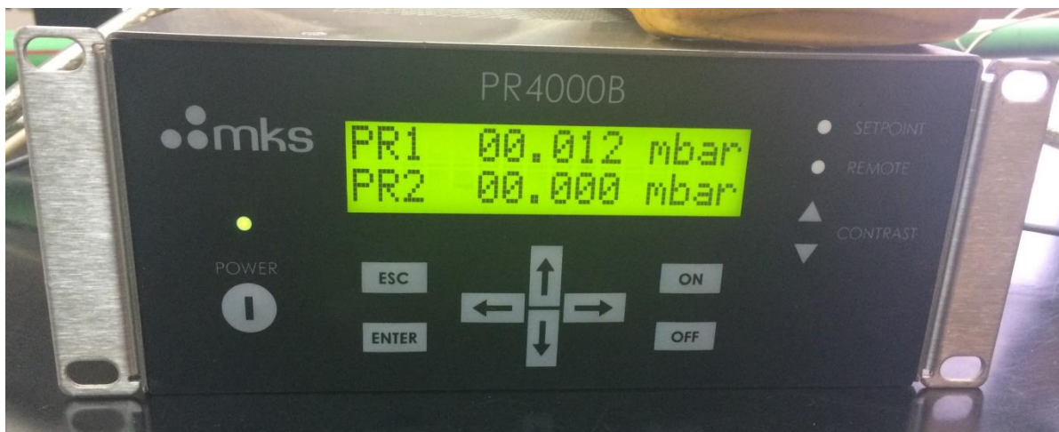
Slika 15. Digitalni tlakomjer PR4000B
