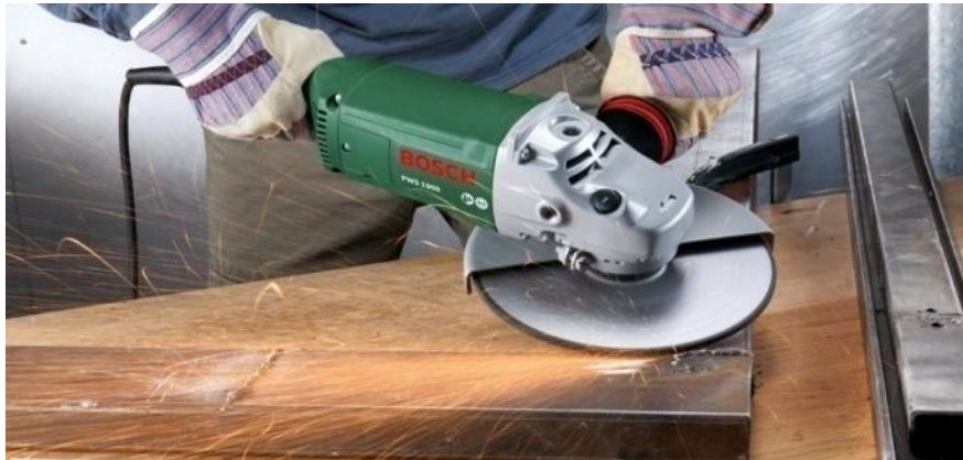
Slika 3. Brušenje zavarenog spoja [11]
