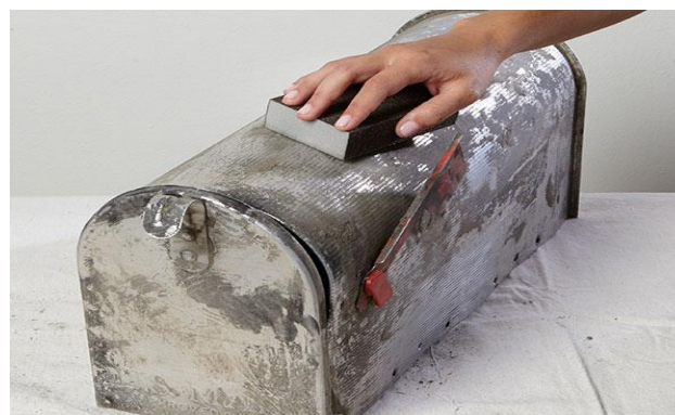
Slika 2. Ručno mehaničko čišćenje metalnog sandučića [10]
