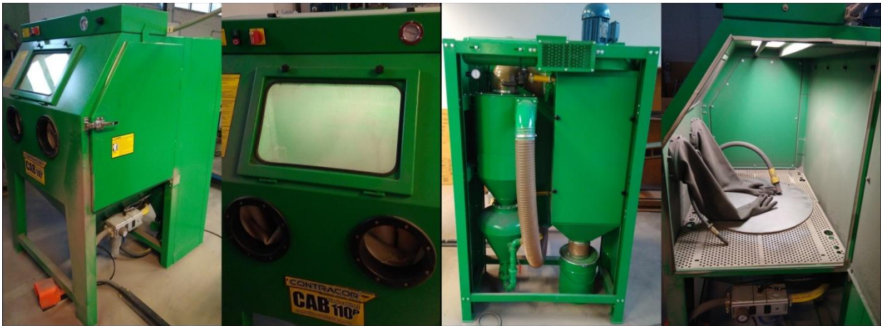
Slika 29. Komora za pjeskarenje „Contracor CAB 110P“, Laboratorij za ljevarstvo, FSB, Zagreb
