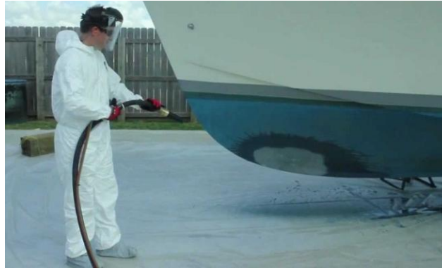
Slika 5. Čišćenje oplata broda mlazom abraziva [13]
