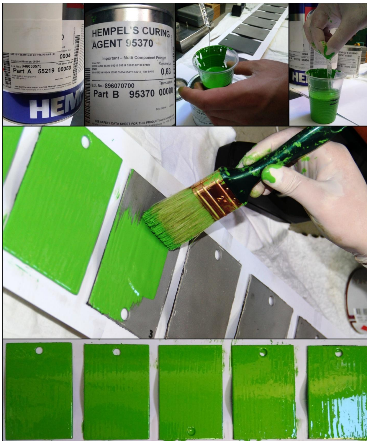
Slika 41. Postupak nanošenja premaza
