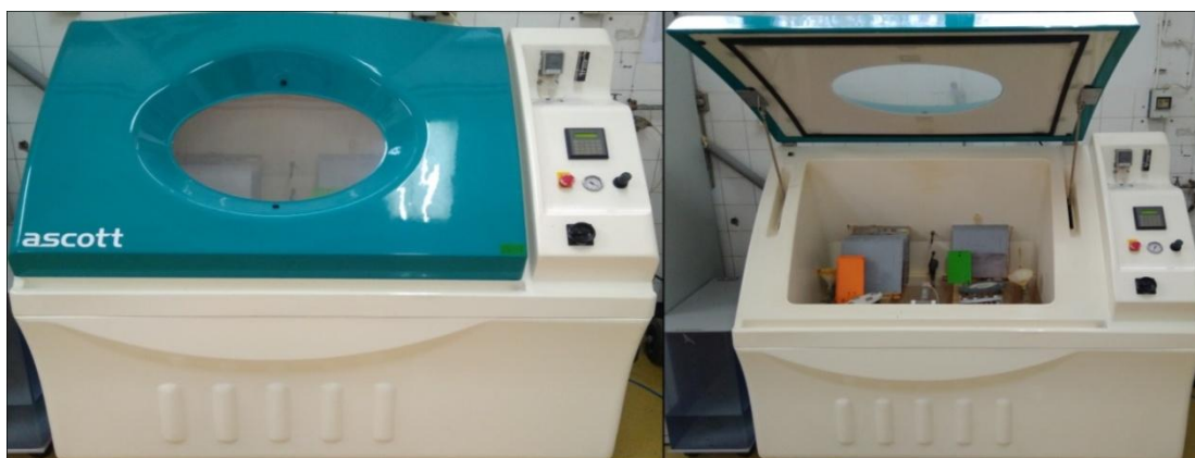
Slika 46. Slana komora „Ascott S450“, Laboratorij za zaštitu materijala, FSB, Zagreb
