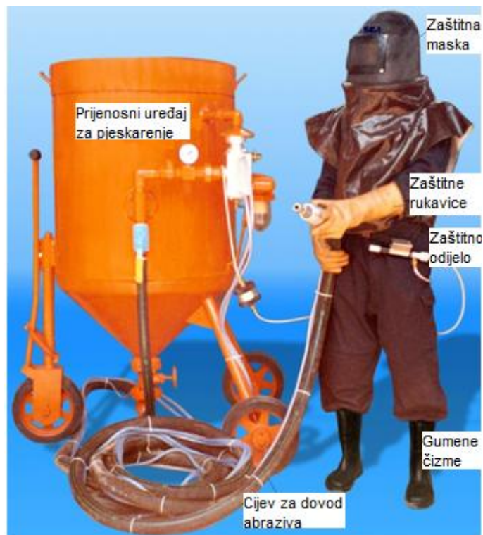
Slika 11. Operator i glavne komponente prijenosne opreme za pjeskarenje [16]
