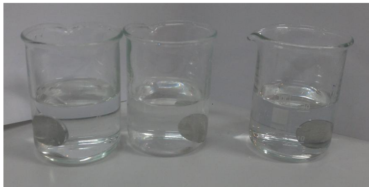
Slika 32. Priprema uzoraka taloženjem cerija
