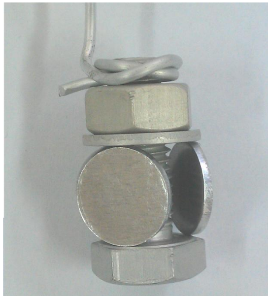
Slika 24. Uzorci stegnuti na vijku
