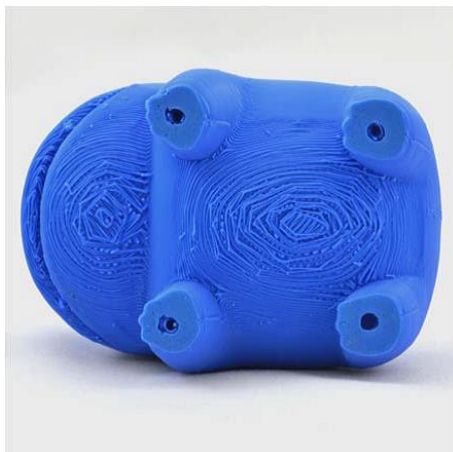
Slika 3.33. Loša površina proizvoda iznad podupora [12]
