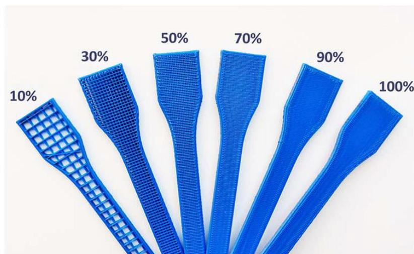
Slika 4.1. Prikaz postotka ispune na ispitnim epruvtama [12]
