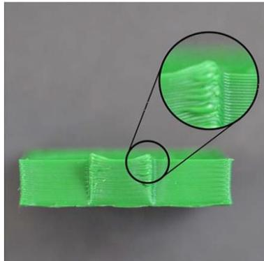
Slika 3.25. Savijanje slojeva [12]
