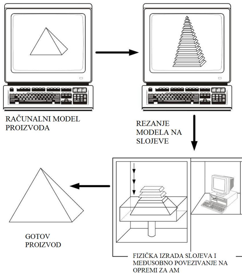
Slika 2.5. Osnovni koraci pravljenja proizvoda postupcima aditivne proizvodnje
