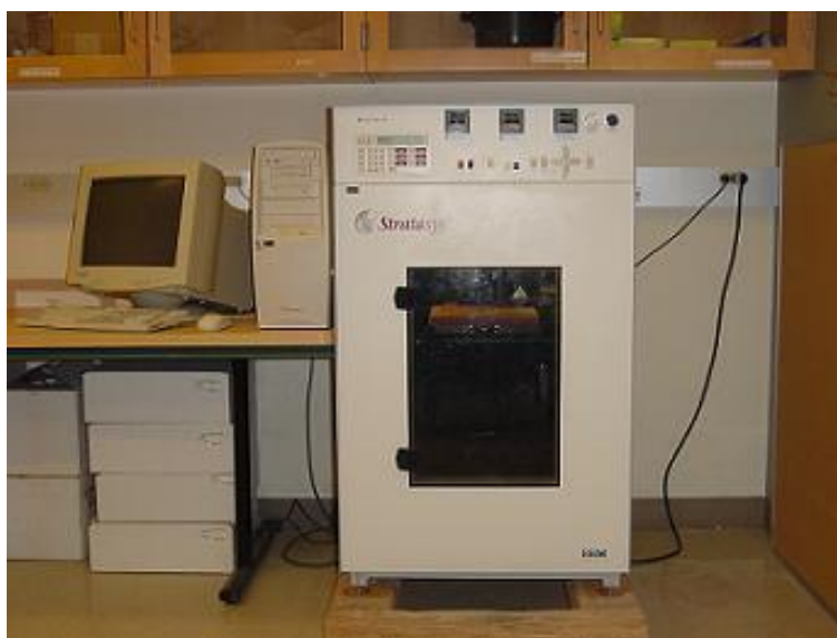
Slika 3.1. Prvi FDM stroj [6]
