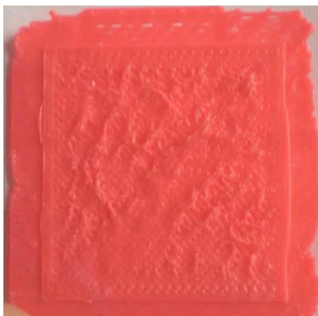
Slika 3.11. Pogreška prvog sloja [12]
