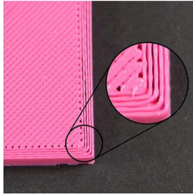
Slika 3.12. Nedovoljno ekstrudiranje materijala [12]
