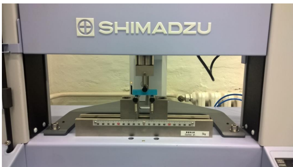
Slika 7.1. Kidalica na kojoj se vršilo ispitivanje
