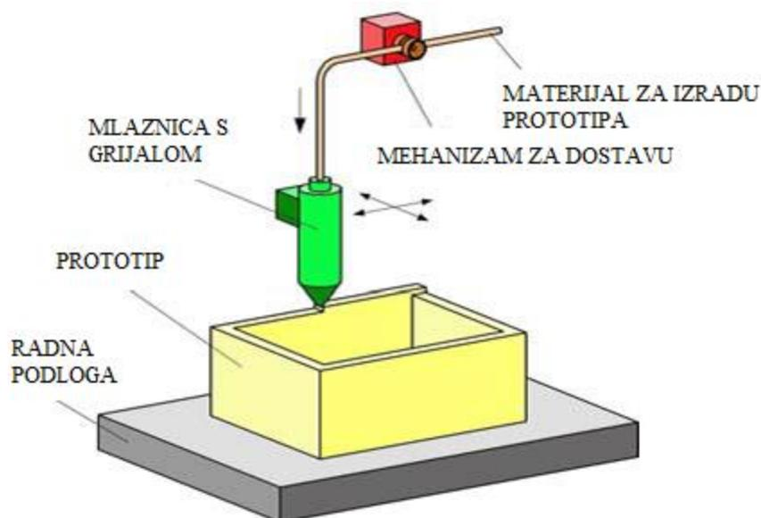
Slika 3.2. Načelo postupka taložnog očvršćivanja (FDM) [8]
