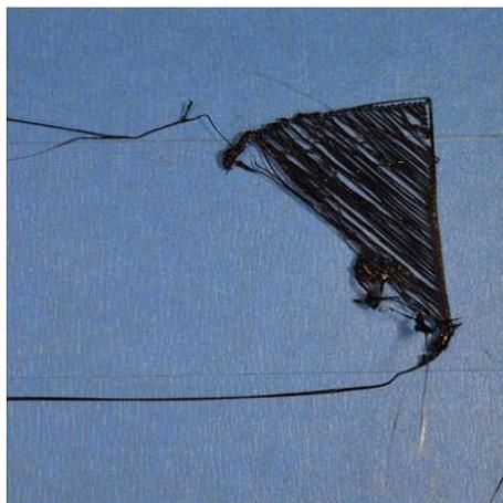
Slika 3.10. Filament odlijepljen od radne podloge [12]
