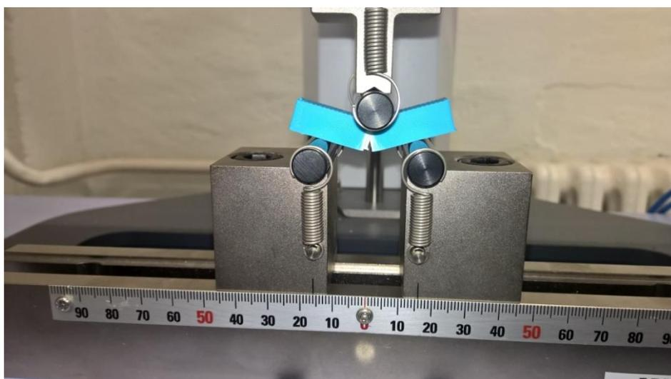
Slika 7.2. Puknuće epruvete
