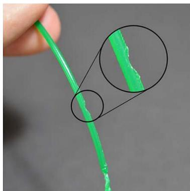
Slika 3.19. Brušenje filameta [12]
