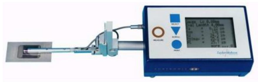
Slika 26. električno-mehaničkom uređaj s ticalom Perthometer S8P [26]
