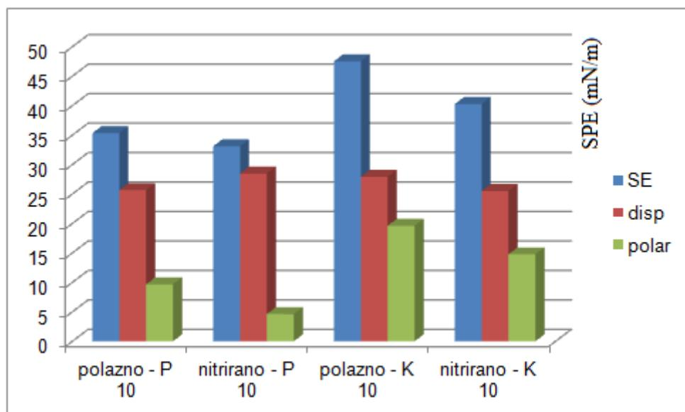
**Slika 25. Grafički prikaz promjene vrijednosti slobodne površinske energije te njezine disperzne i polarne komponente**
