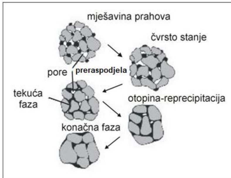
Slika 5. Faze zgušnjavanja tijekom sinteriranja u tekućoj fazi [5]
