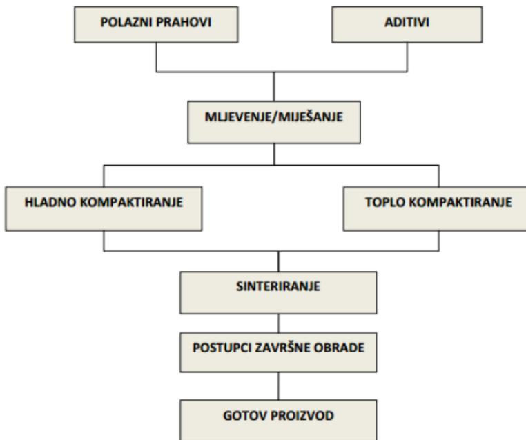
**Slika 2. Tehnološki postupci proizvodnje tvrdih metala metalurgijom praha [5]**
