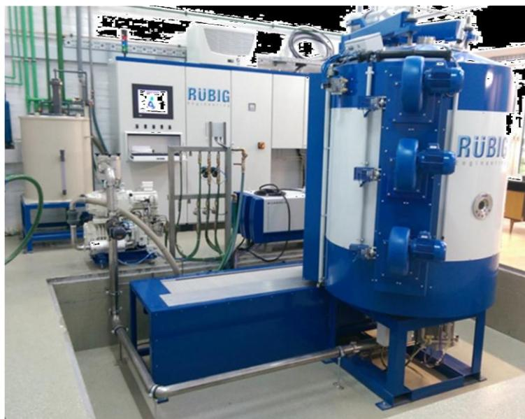
**Slika 16. Uređaj MICROPULS PACVD PC 70/90 (Rübig GmbH&Co KG) [22]**
