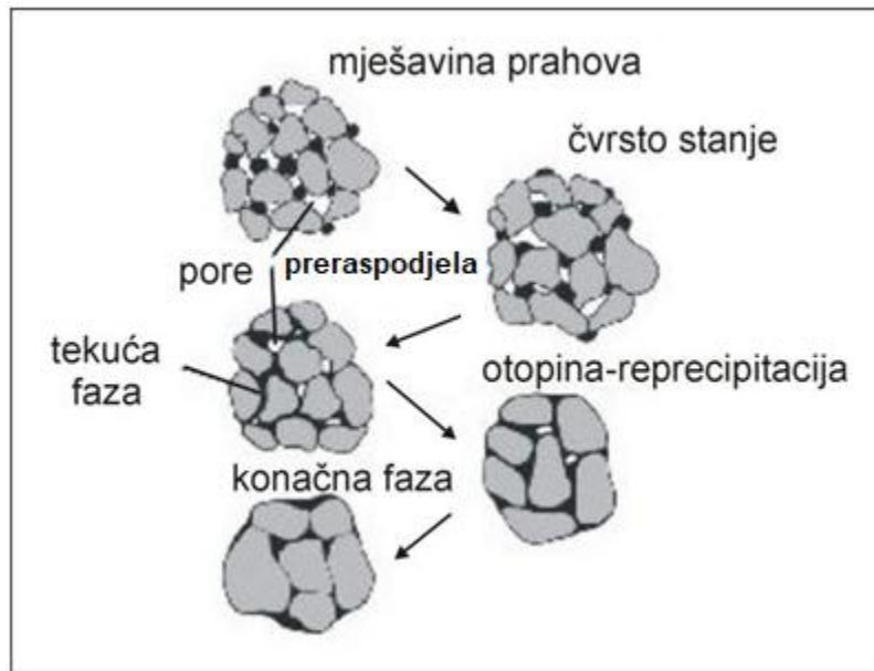
Slika 5. Faze zgušnjavanja tijekom sinteriranja u tekućoj fazi [5]
