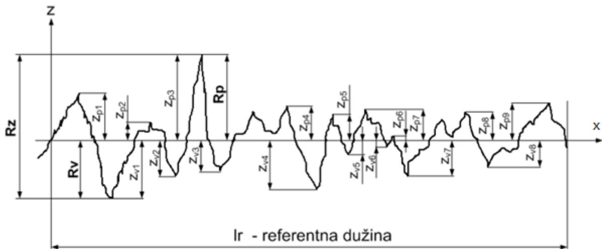
Slika 28. Vrijednosti  $R_p$ ,  $R_v$ ,  $R_z$  na profilu hrapavosti [25]
