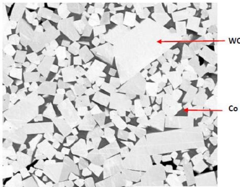
Slika 6. Primjer mikrostrukture tvrdog metala [6]
