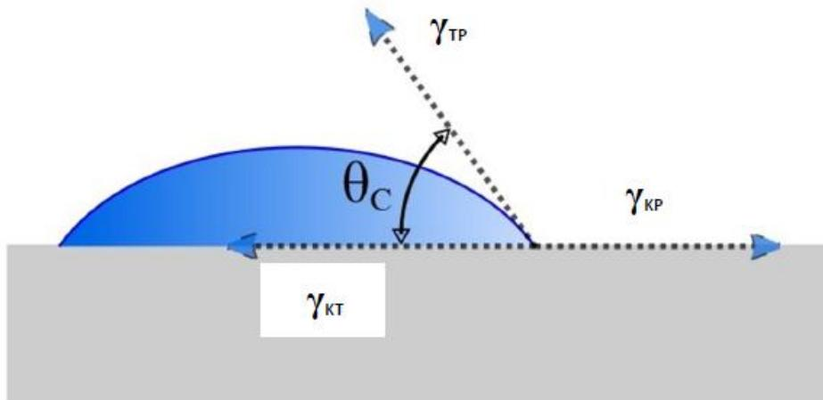
Slika 23. Shematski prikaz mjerjenje kuta kvašenja [22]
