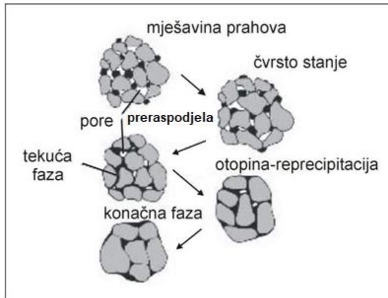
Slika 5. Faze zgušnjavanja tijekom sinteriranja u tekućoj fazi [5]
