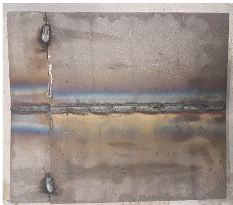
Slika 14. Zavarena ploča od čelika S355J0WP – korijen zavora
