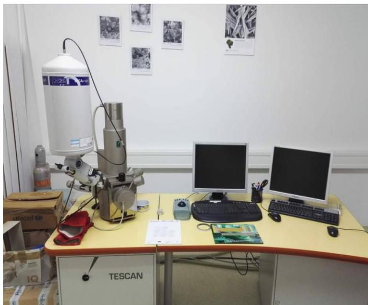
**Slika 32. Skenirajući elektronski mikroskop (SEM) Tescan Vega TS5136LS [56]**
