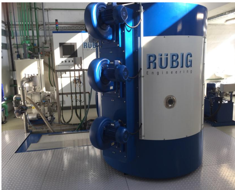
Slika 36. Industrijska peć RUBIG GmbH Type PC 70/90 instalirana na Fakultetu strojarstva i brodogradnje [56]
