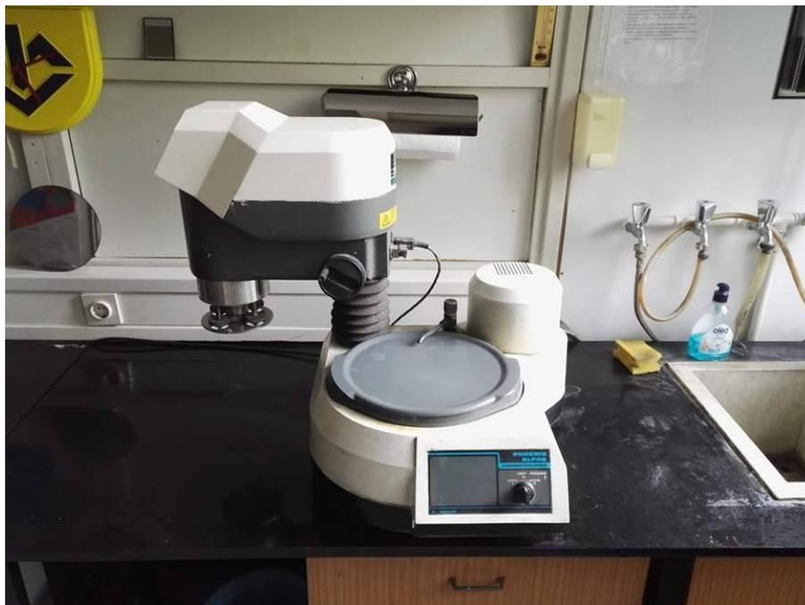
**Slika 35. Buehler Phoenix Alpha uređaj za poliranje [56]**
