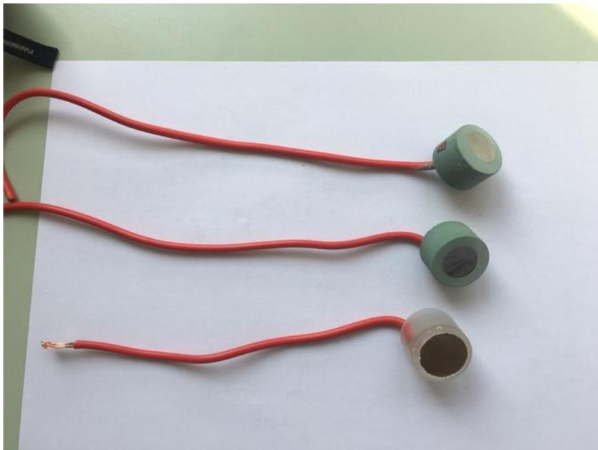
**Slika 38. Uzorci pripremljeni za elektrokemijska ispitivanja [56]**
