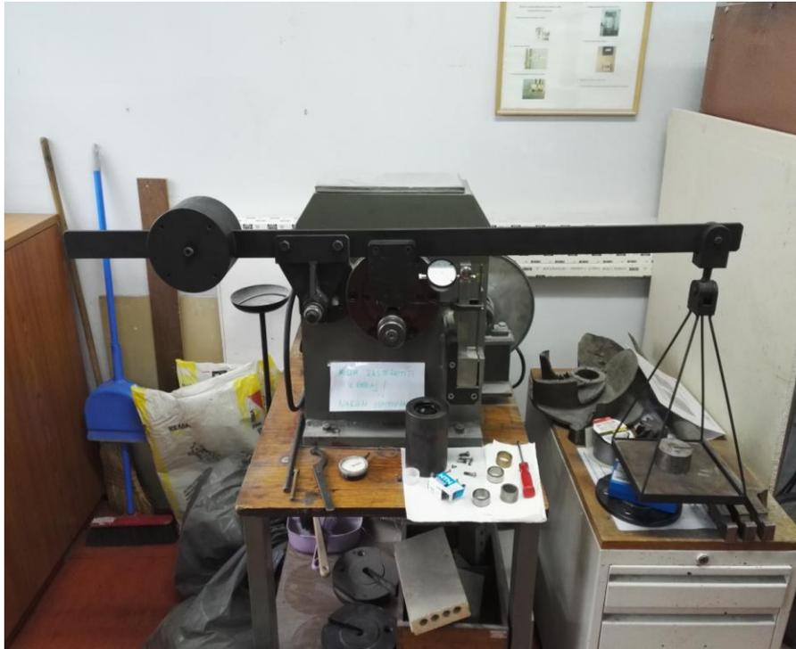
**Slika 44. Uređaj za ispitivanje otpornosti na adhezijsko trošenje**
