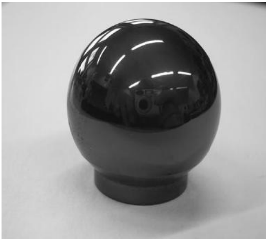
Slika 14. DLC prevlaka na zglobnom implantatu [32]
