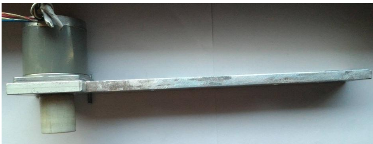
Slika 24. Koračni motor na nosaču
