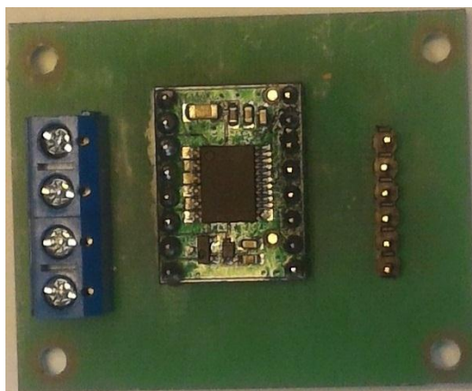
Slika 63. Izrađena tiskana pločica upravljačkog sklopa za istosmjerni motor
