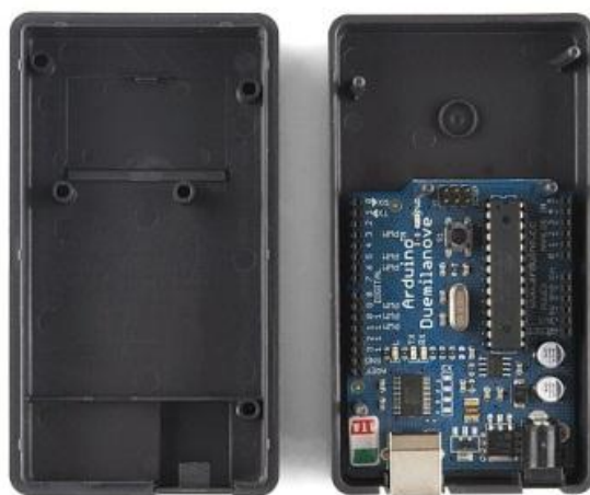
Slika 68. Spoj platforme Arduino s kućištem [27]
