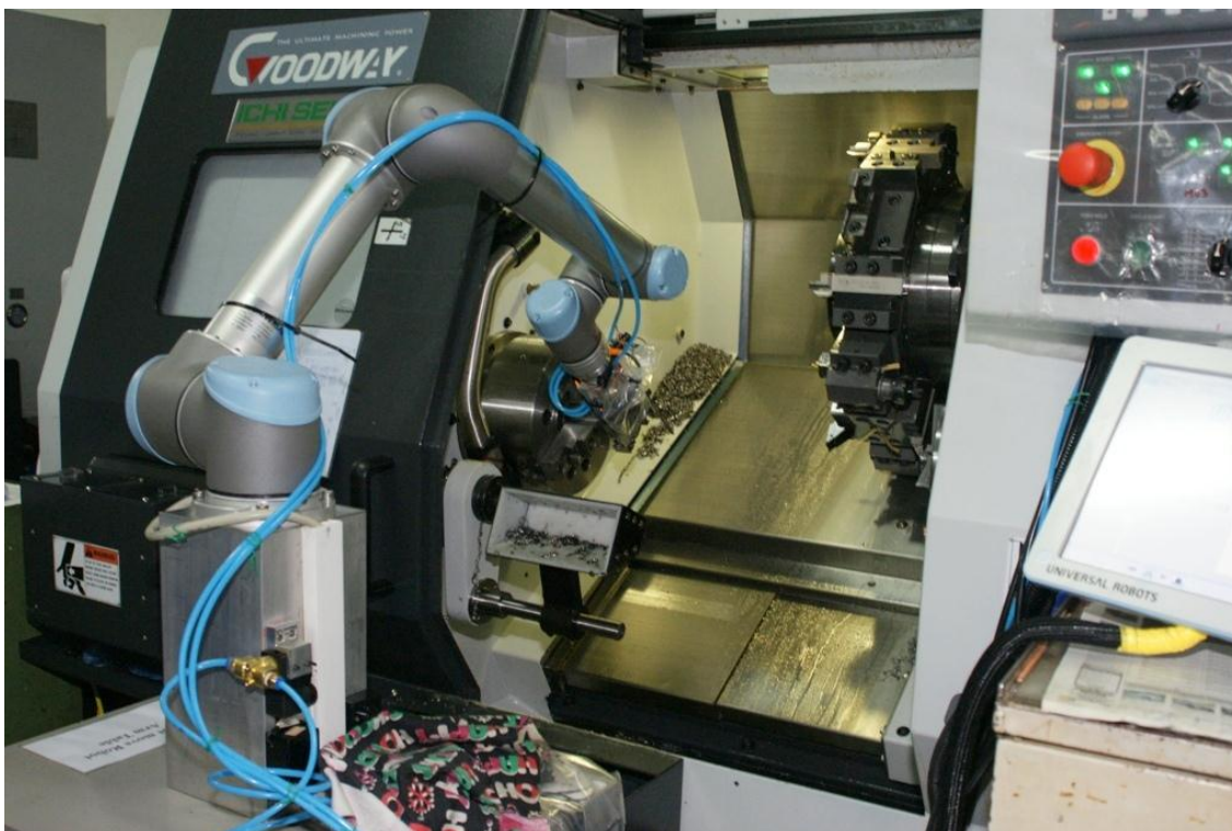
Slika 2. Robot nadograđen na CNC tokarilicu [3]
