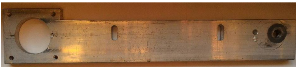
Slika 23. Nosač motora pokretne trake
