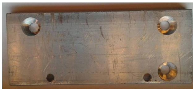
Slika 22. Nosač za spajanje pokretne trake na postolje manipulatora
