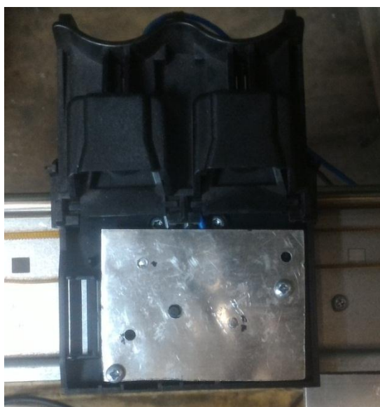
Slika 61. Konstrukcija kućišta električnog tipkala
