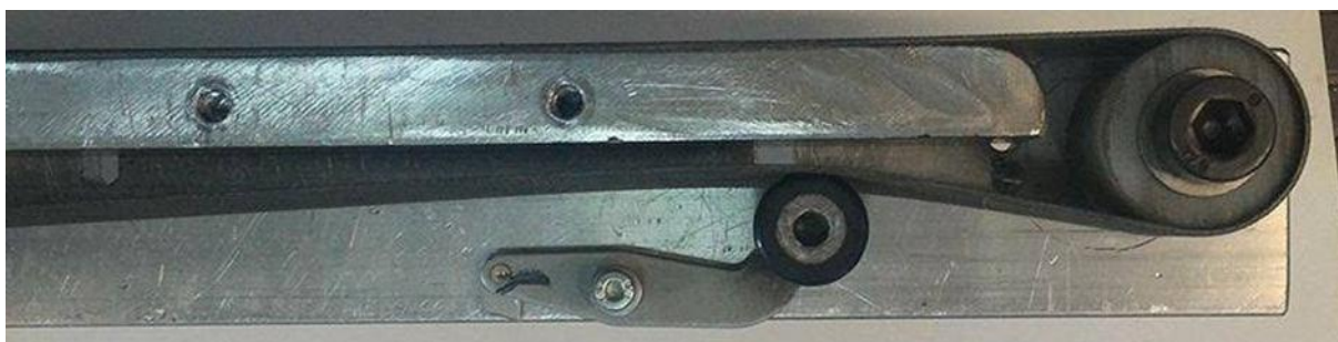
Slika 31. Priteznik na transportnoj traci
