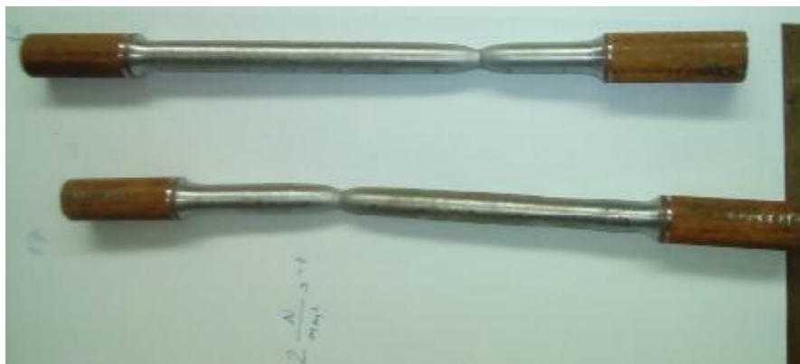
Slika 10 Epruvete nakon ispitivanja pri brzini prirasta opterećenja 2 \text{ N/mm}^2 \cdot \text{s}^{-1}
