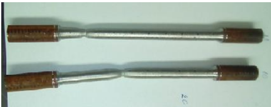
Slika 13 Epruvete nakon ispitivanja pri brzini prirasta opterećenja 20 \text{ N/mm}^2 \cdot \text{s}^{-1}
