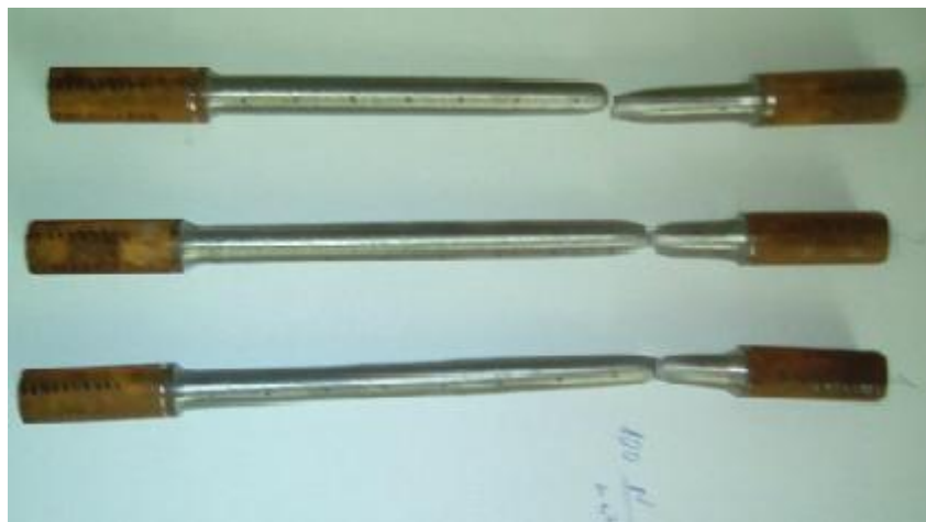
Slika 16 Epruvete nakon ispitivanja pri brzini prirasta opterećenja 100 \text{ N/mm}^2 \cdot \text{s}^{-1}
