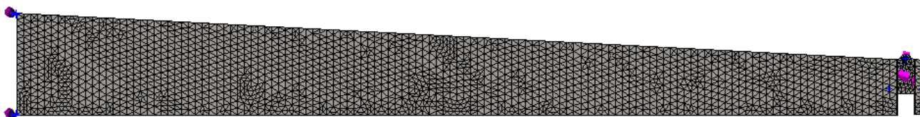
Slika 24. Detaljniji prikaz mreže konačnih elemenata
