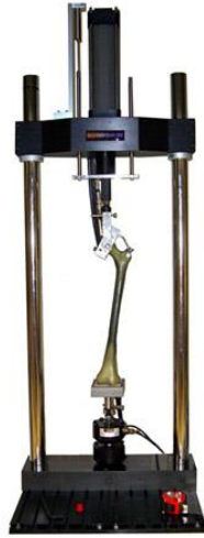
Slika 10. Vlačno ispitivanje kosti [13]
