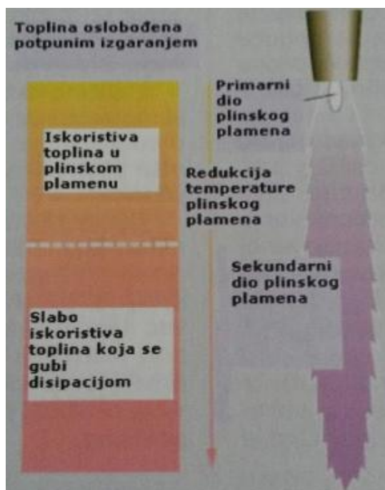
Slika 2. Iskoristivost toplinske energije po dubini plamena [3]
