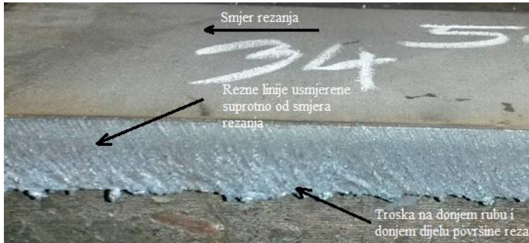
Slika 42. Nepravilnosti reza na uzorku 3
