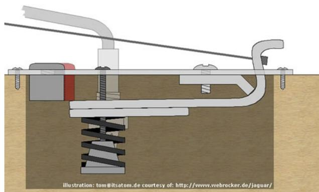
Slika 7. Shema mehanizma Floating tremola [8]
