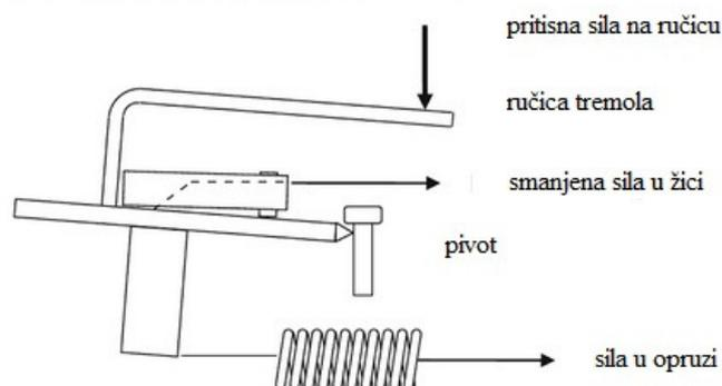
Slika 5. Prikaz rada synchronised tremola [6]
