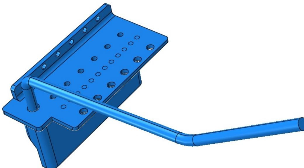
**Slika 27. Pojednostavljeni model tremola za numeričku analizu**
