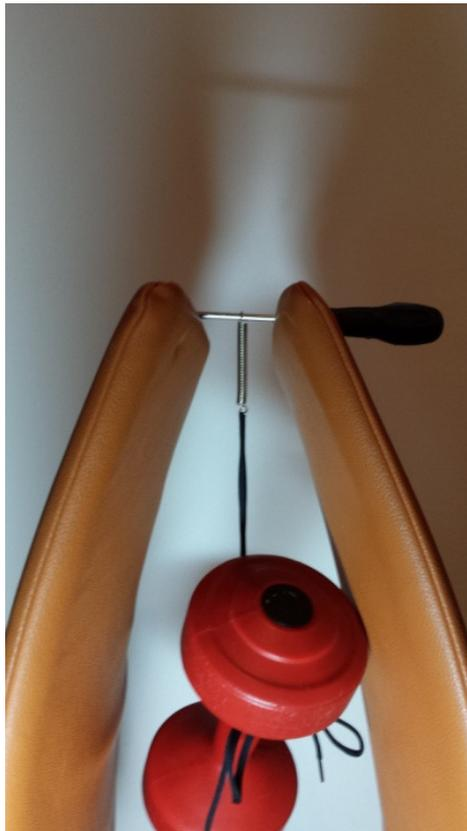
**Slika 19. Sustav opruge i utega u vertikalnom sustavu**
