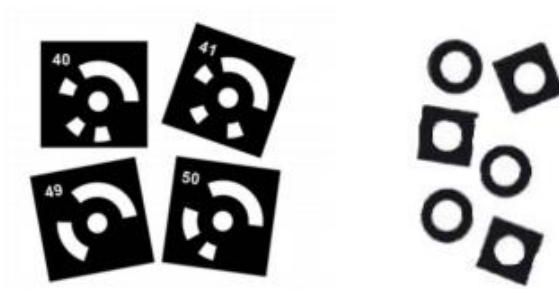
Slika 7. Mjerne točke (markeri), kodirane i nekodirane [7]
