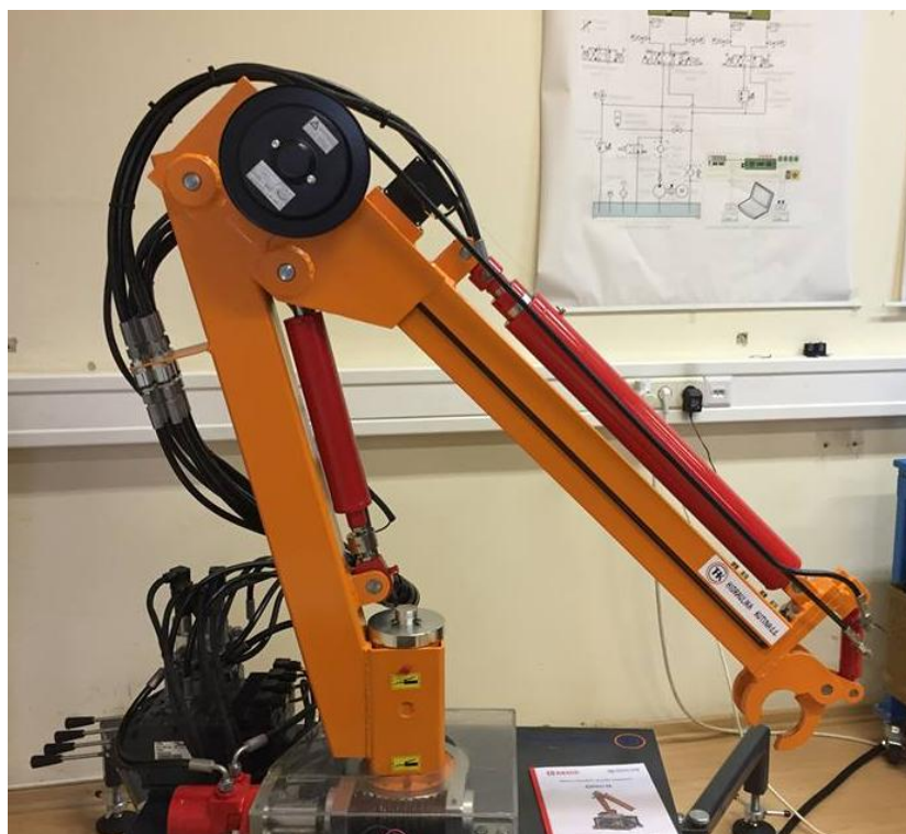
Slika 1. Elektrohidraulički robotski manipulator
