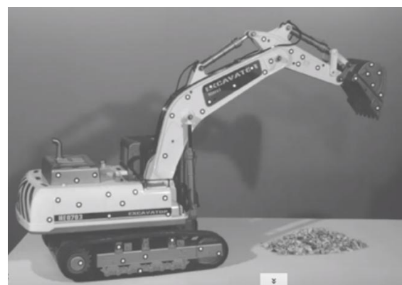
Slika 8. Pripremljeni mjerni objekt s referentnim markerima [6]
