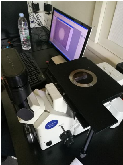
Slika 14. Ispitivanje traga trošenja na svjetlosnom mikroskopu
