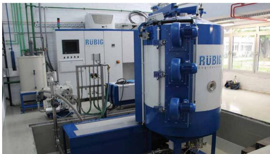
Slika 4. Uređaj RÜBIG PC 70/90 instaliran na FSB-u [3]
