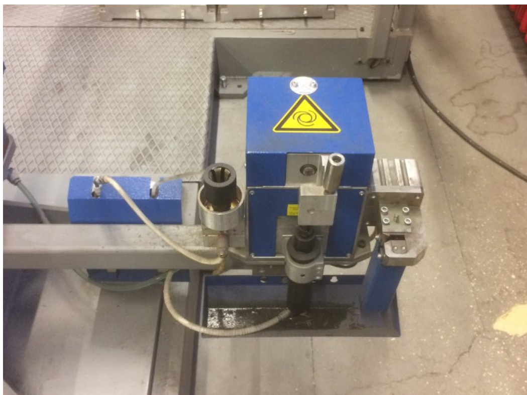
Slika 23. Sustav za čišćenje pištolja i rezanje žice
