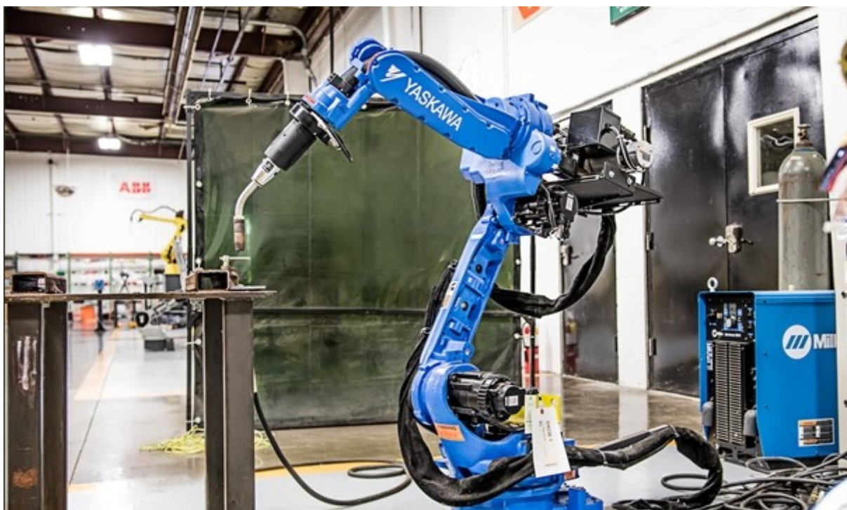
Slika 16. Robotski manipulator za MIG/MAG zavarivanje [25]
