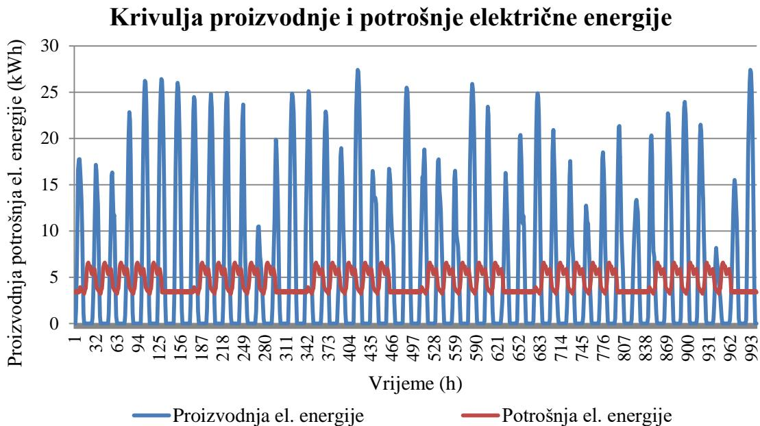
**Slika 4. Prikaz krivulja proizvodnje i potrošnje za period od 25.3.2014. 04:00 do 5.5.2014. 21:00 na primjeru OŠ Slakva Kolar (instalirana snaga 34,7 kW)**
