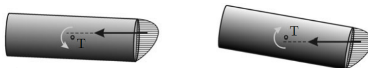
Slika 2.12. Stabilizacija otporom zraka [2]. Tamna strelica predstavlja redukciju tlaka na prednju plohu u silu, a svjetla moment te sile oko težišta (T)
