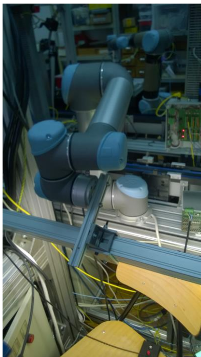
Slika 17: Robot UR5 s improviziranom hvataljkom za svjetlo
