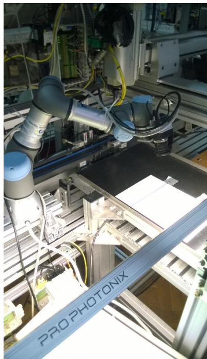
Slika 10: Robot UR3 s montiranom kamerom
