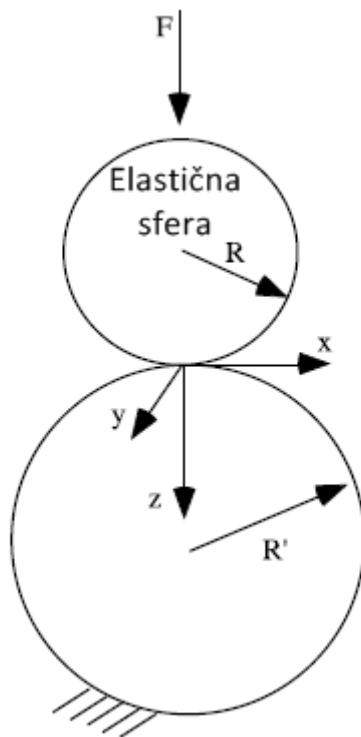
Slika 4. Shematski dijagram za Hertzov kontaktni model [4]
