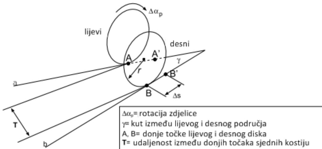
Slika 6. Model kotrljanja zdjelice po tvrdoj površini pri rotaciji [5]
