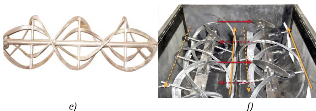
Sl. 3.9 Primjeri trakastih spiralnih oštrica kod Ribbon blendera
