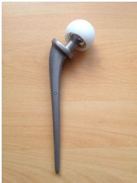
Slika 11. Uzorak endoproteze s referentnim točkama
