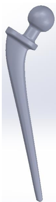
Slika 14. Dobiveni model femuralne komponente endoproteze
