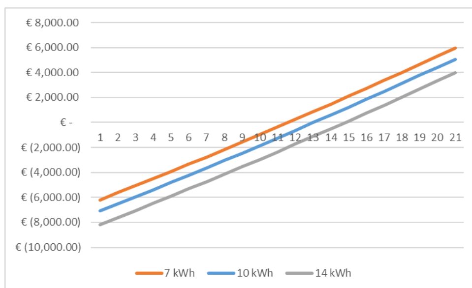
Slika 12. Cash flow kroz godine tvrtke B za kapacitet baterija od 7 kWh, 10 kWh te 14 kWh po kućanstvu
