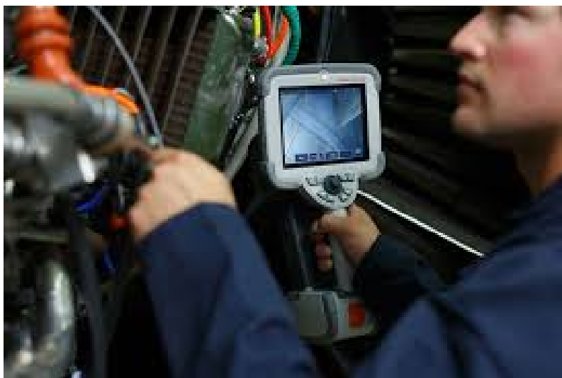
Slika 6: Vizualna metoda ispitivanja [16]
