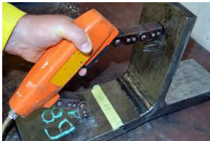
Slika 8: Ispitivanje magnetskim česticama [18]
