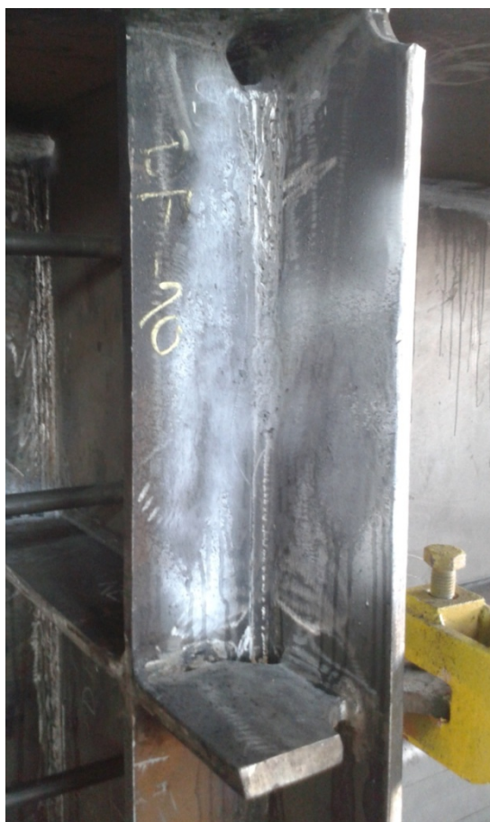
Slika 15: Pozicije na MS1 ispitivane MT metodom - Područje uški [25]
