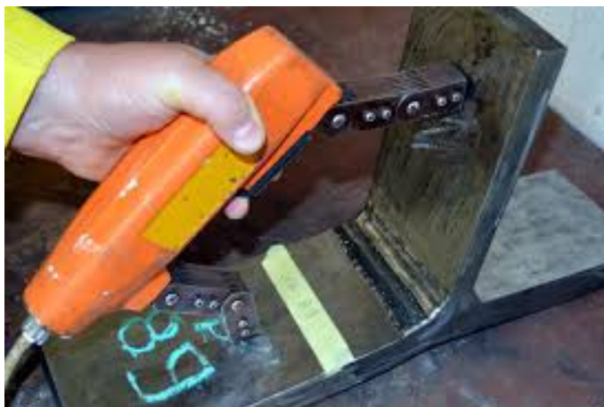
Slika 8: Ispitivanje magnetskim česticama [18]
