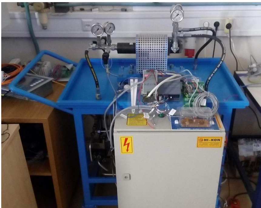
Slika 24 Eksperimentalni postav za regulaciju rotacijskog gibanja
