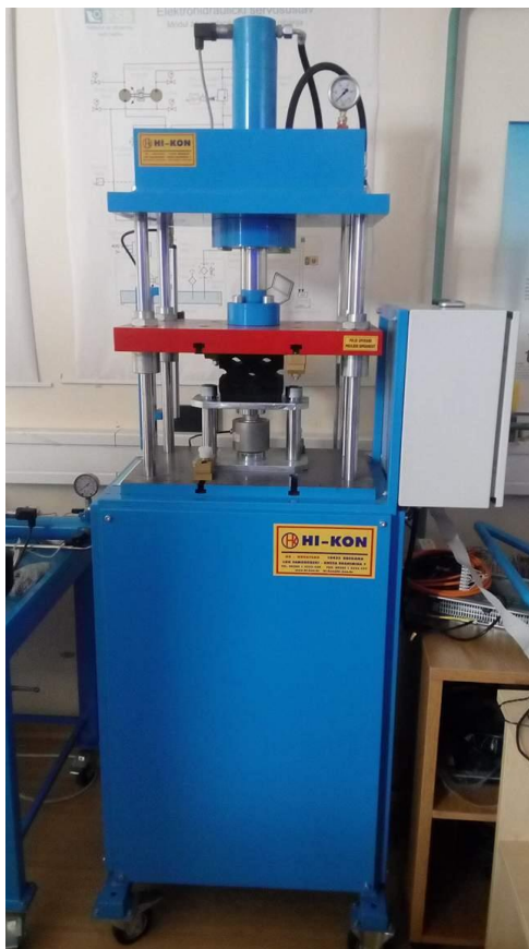
Slika 28 Eksperimentalni postav za regulaciju sile
