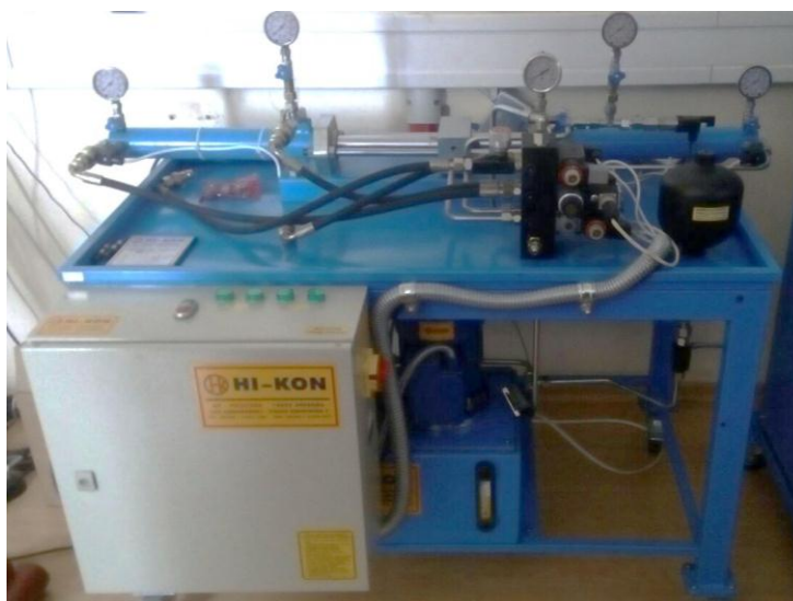
Slika 17 Eksperimentalni postav za regulaciju translacijskog gibanja
