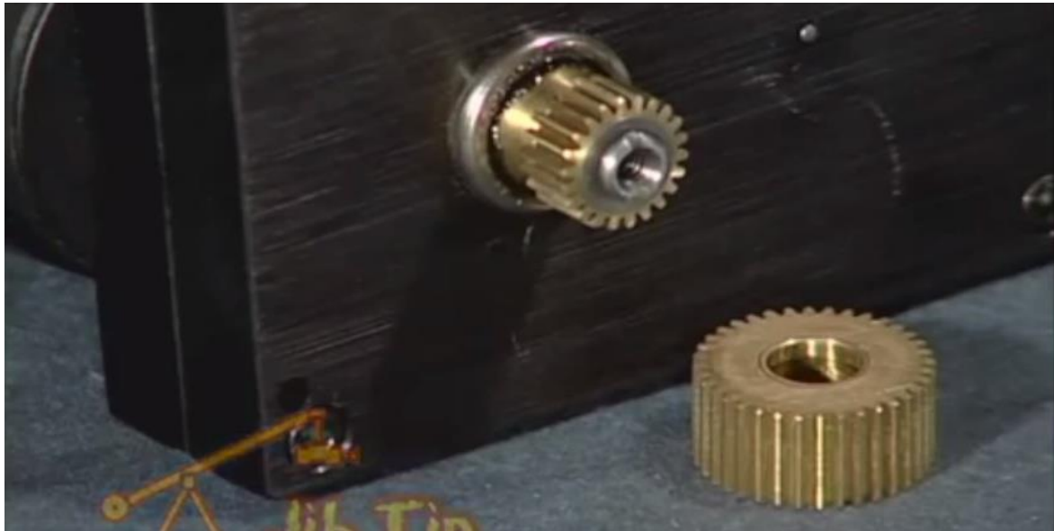
Slika 32. Pogonski zupčanik sa 22 i 36 zubi [25]
