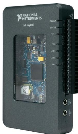
Slika 11. Upravljački uređaj myRIO-1900
