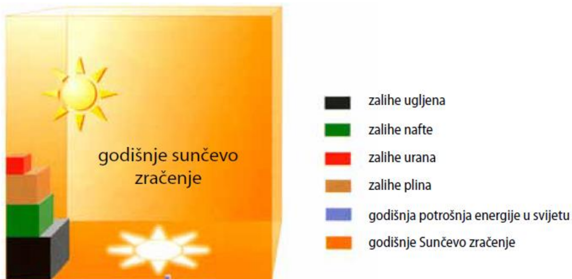
Slika 3. Usporedba godišnjeg zračenja na površini Zemlje, zaliha fosilnih i nuklearnih goriva, te potrošnje energije u svijetu [7]
