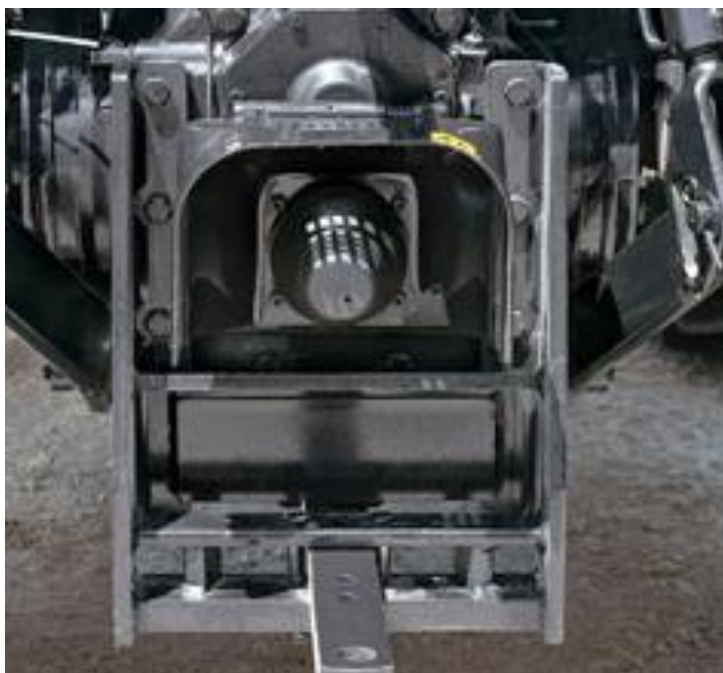
Slika 13. Izlazni priključak za radno vratilo na traktoru
