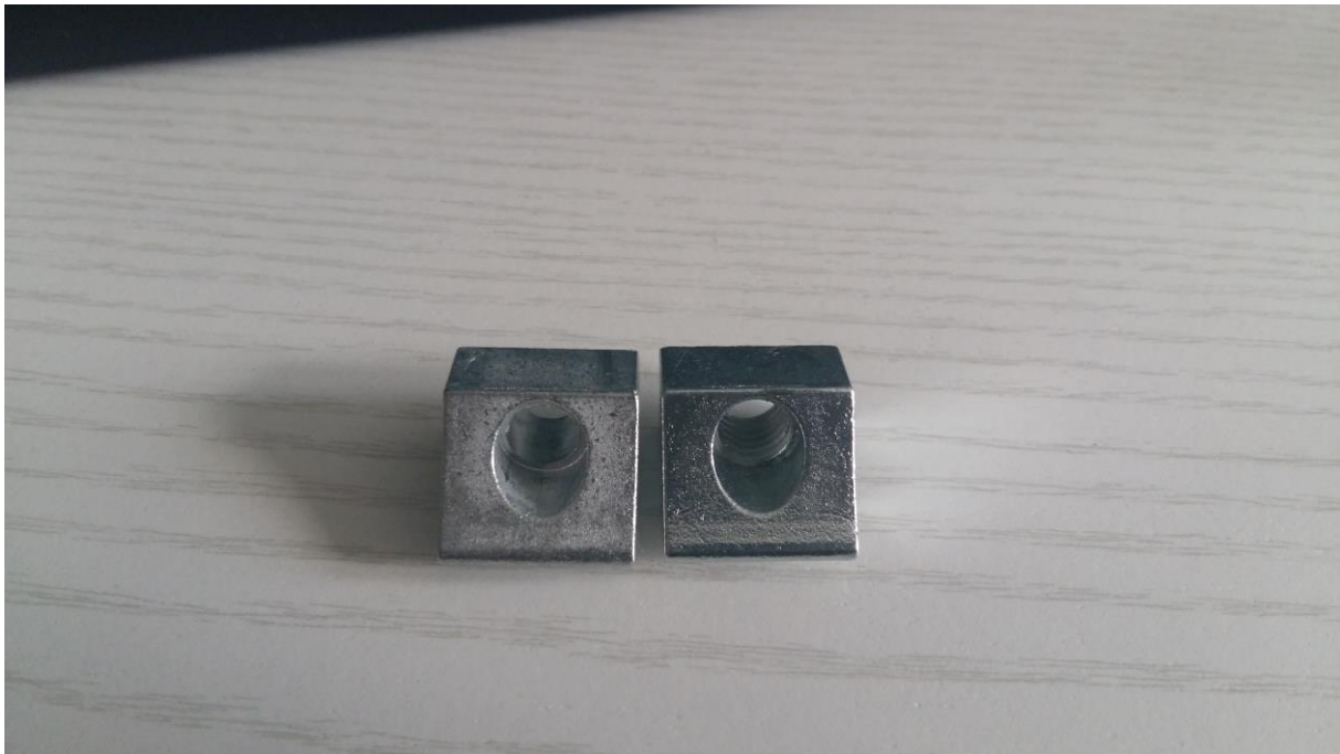
Slika 12. Dio „A“: lijevo – tek odlijevan; desno – nakon svih obrada
