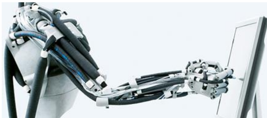
Slika 12. Festo-ovi mišići na humanoidnom robotu
