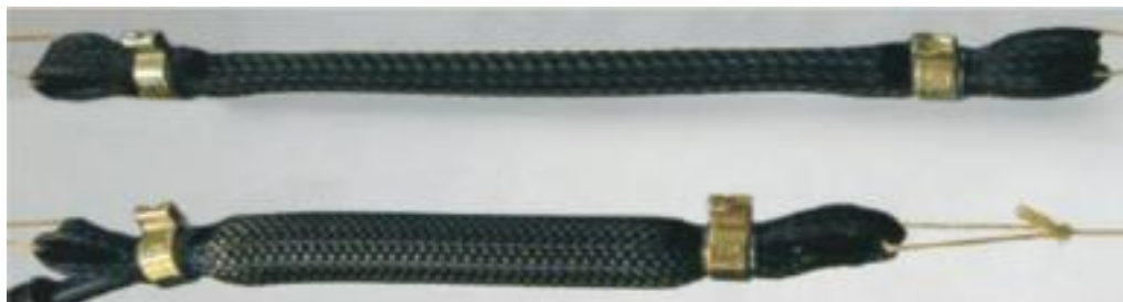
Slika 10. McKibbenov pneumatski mišić
