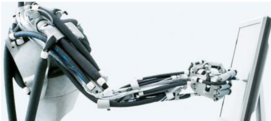
Slika 12. Festo-ovi mišići na humanoidnom robotu
