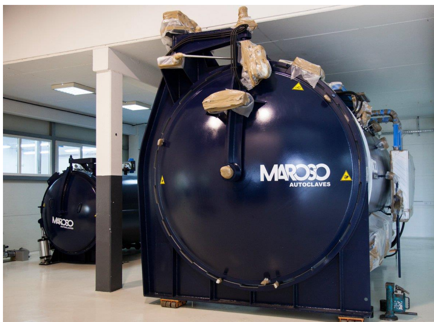
Slika 12. Autoklav – Rimac Automobili
