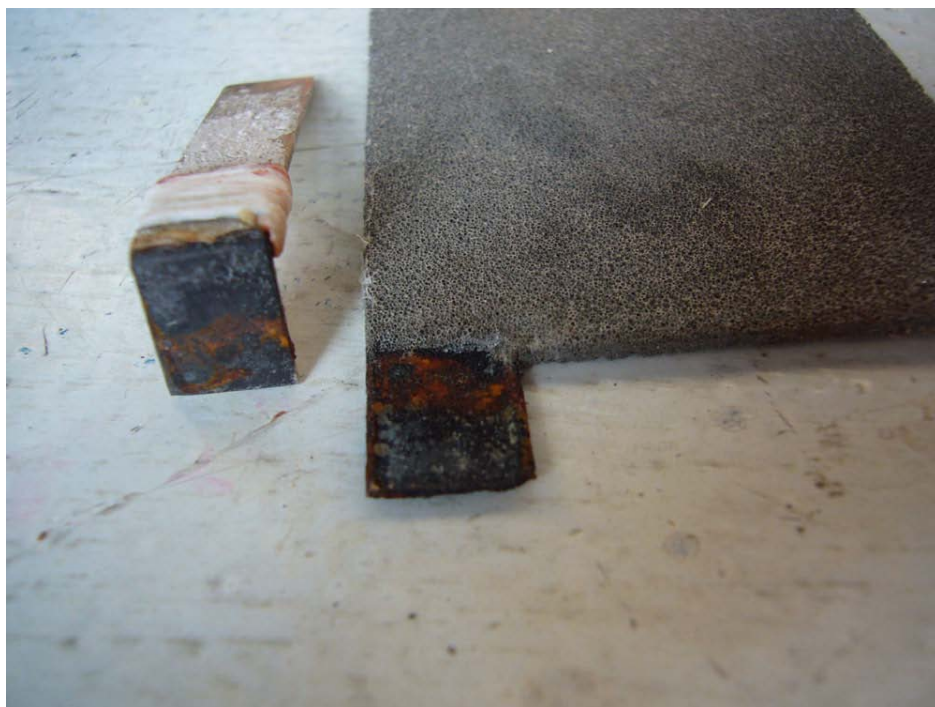
Slika 35. Korozija na spoju elektrode i kontaktne pločice
