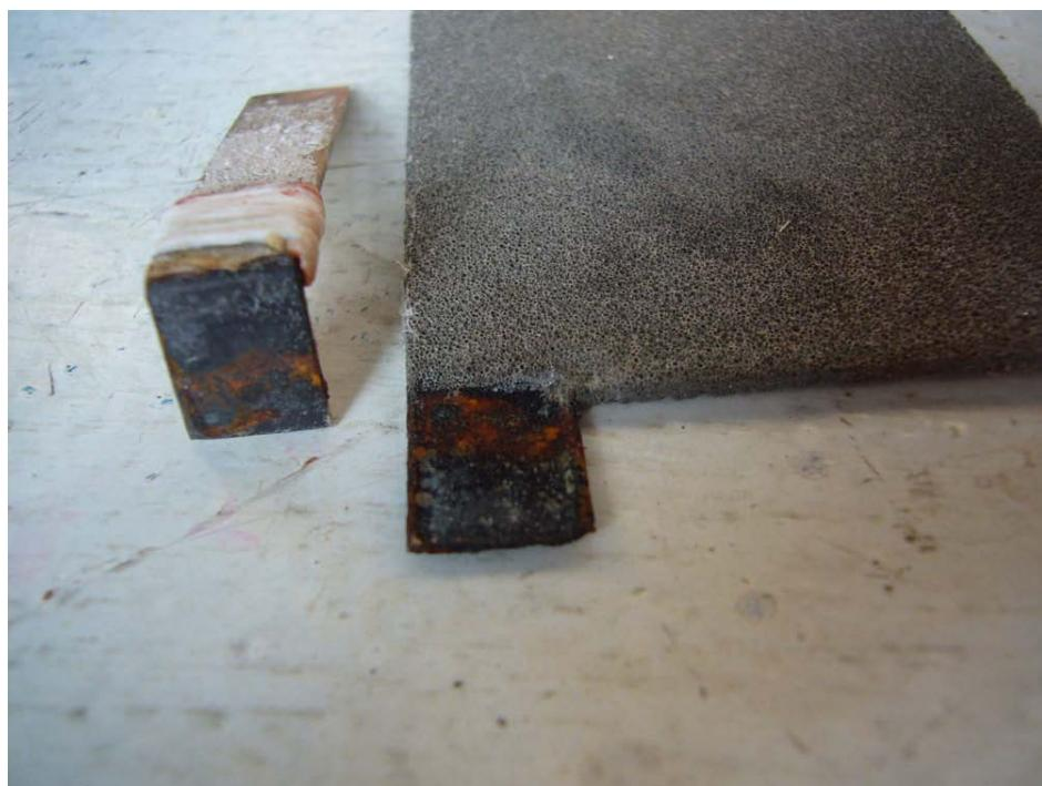
**Slika 35.** Korozija na spoju elektrode i kontaktne ploćice
