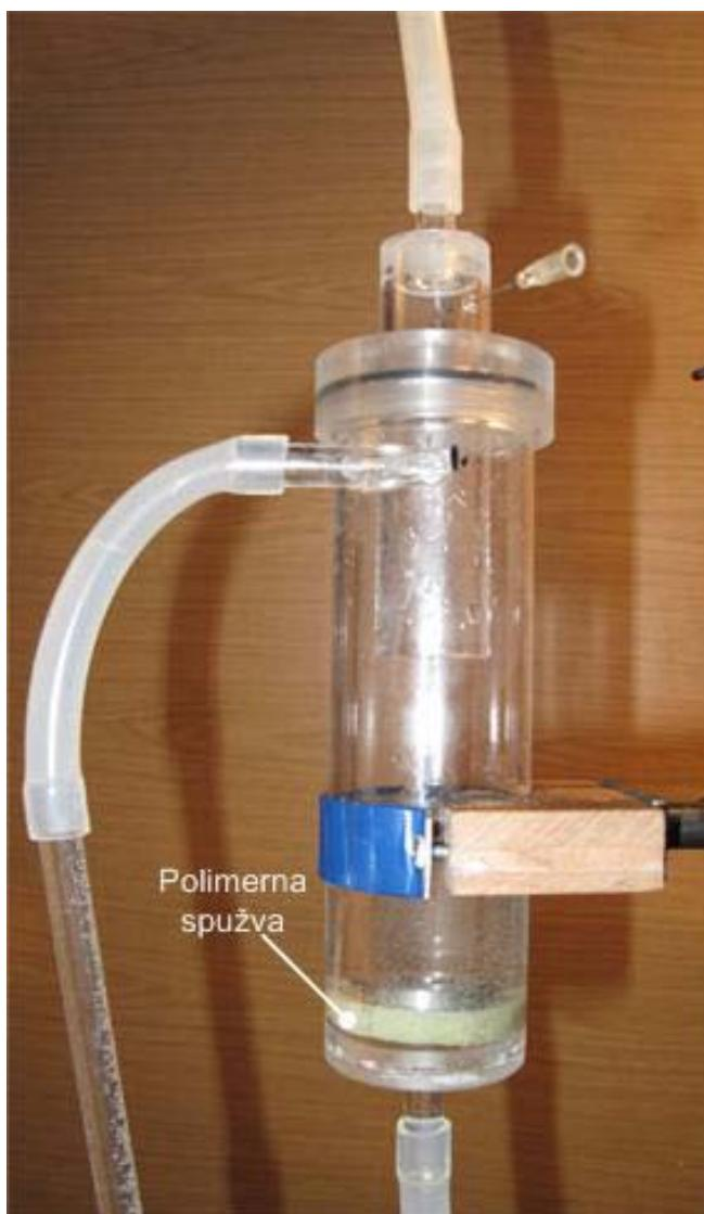
Slika 44. Separator sa spužvom
