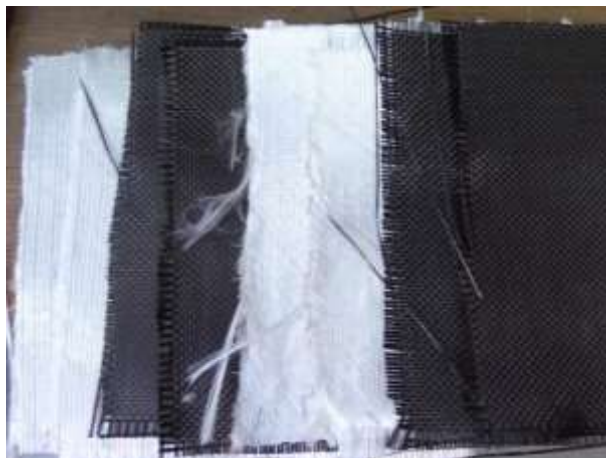
Slika 6.2. Izrezana staklena i ugljična tkanja
