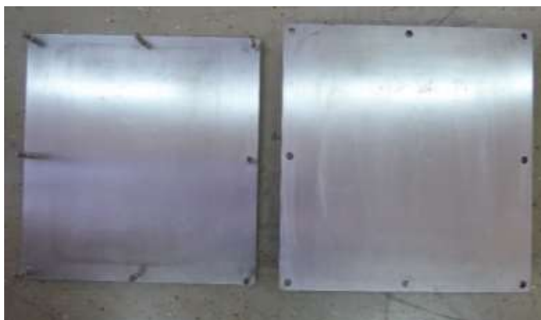
Slika 6.3. Kalup za izravno prešanje
